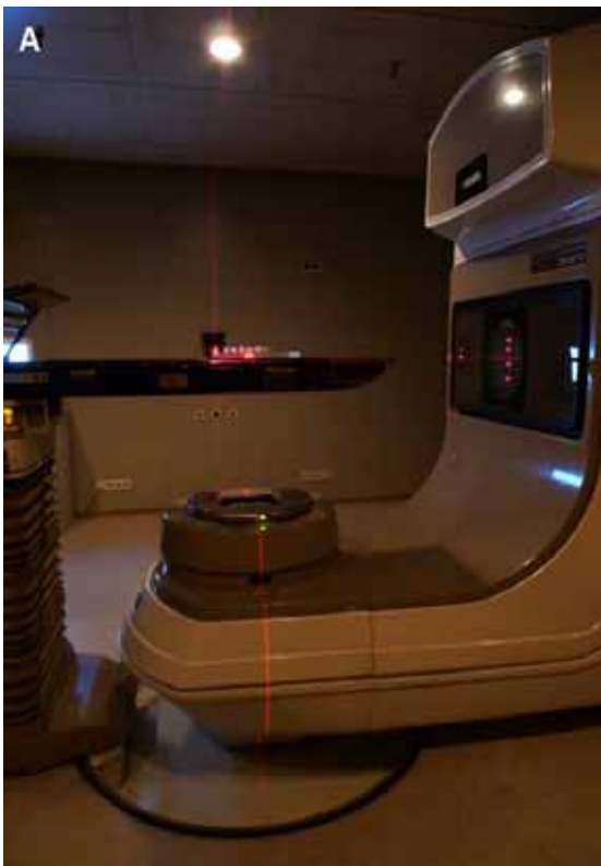
Figura 6. (A) Accelerador lineal i (B) suport de metacrilat emprats per la irradiació de les cèl·lules.
