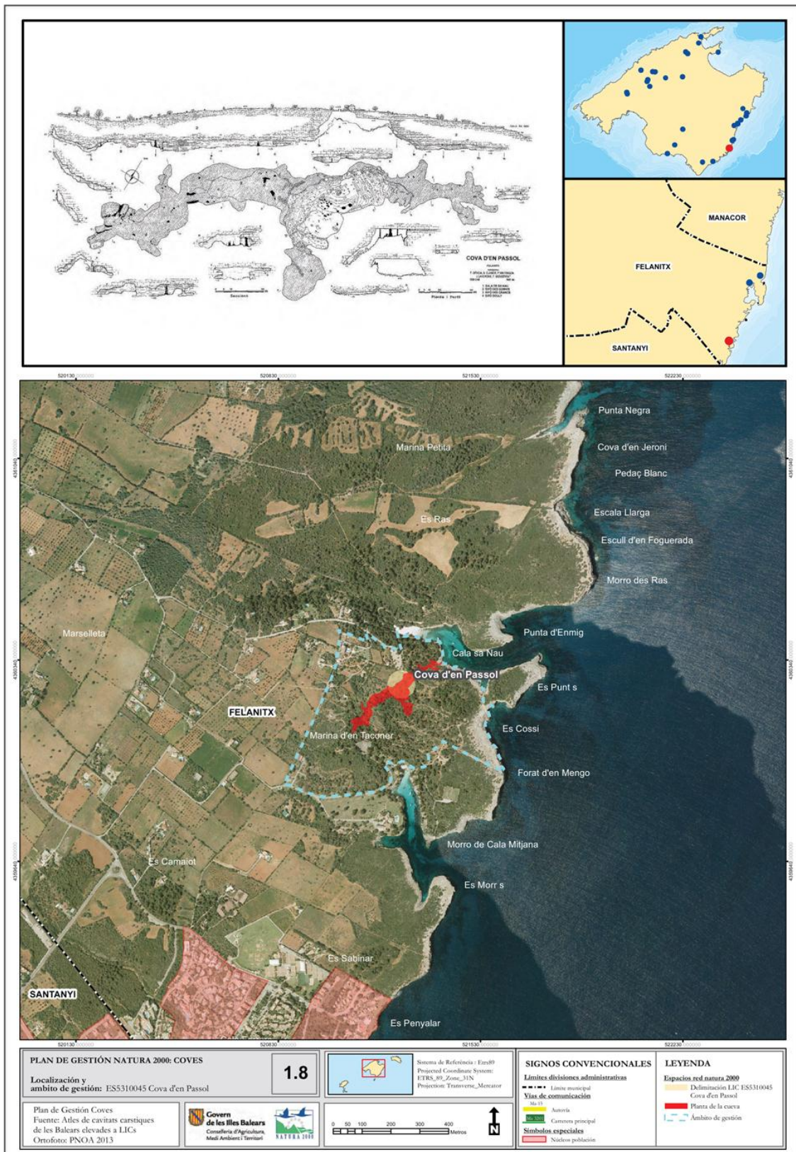
Figura 21.22: Fitxa extreta del Pla de Gestió Natura 2000. Coves, a on es pot apreciar a la fotografia aèria la topografia de la cova d'en Bassol (Cala Sa Nau, Felanitx) superposada. L'àrea feta amb retxes discontinües blaves correspon a l'àrea de protecció que envolta el ZEC. Aquí es veu la importància de la topografia de les cavitats per la planificació territorial i la protecció del medi subterrani. Govern de les Illes Balears.
