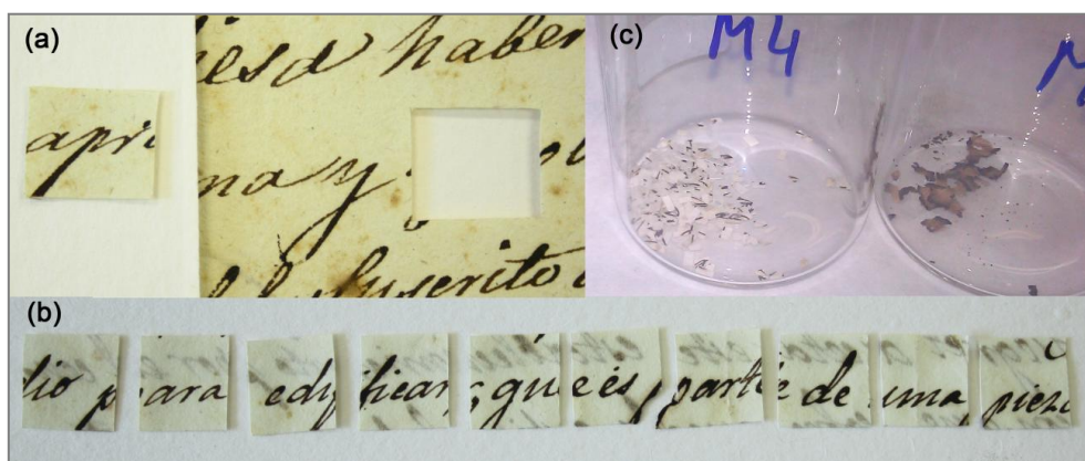
Figura 2.40. Imatges de la destructivitat associada a les determinacions del pH. a) fragment per pH de superfície. b) línia de 10x1 cm per l'extracció, c) aspecte final de la mostra abans de l'addició del solvent.
