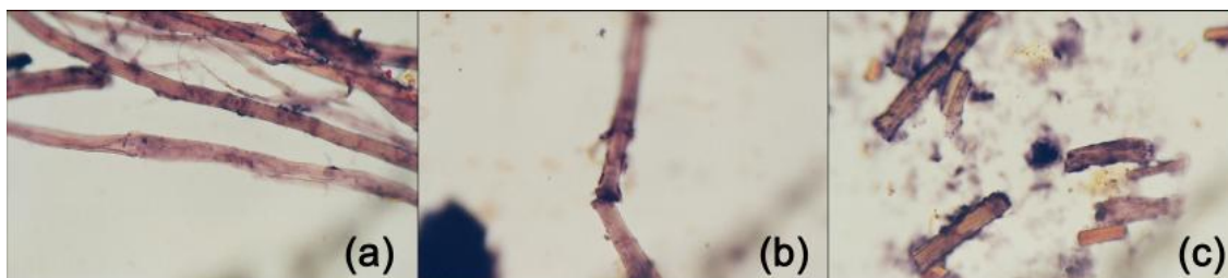
Figure 1.2 . Fibril·lació de les fibres de lí. (a) Fibres en bon estat de conservació (b) Fibres poc degradades (c) Fibres amb degradació avançada.(coloració mitjançant el reactiu de Herzberg, 400x)
