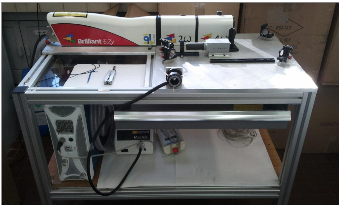
Figura 2.1. Imatge de la Taula amb el sistema òptic, el laser i la càmera de control
