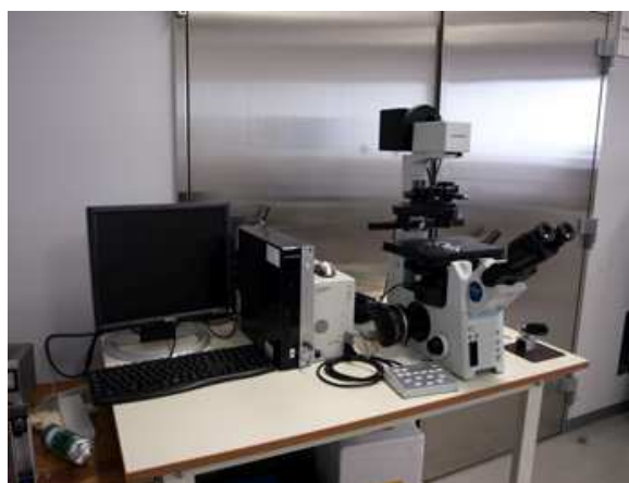
Figura 3.46. Microscopio y cámara digital 1. Sistema Olympus con microscopio óptico, cámara digital y ordenador con programa Cell instalado.
