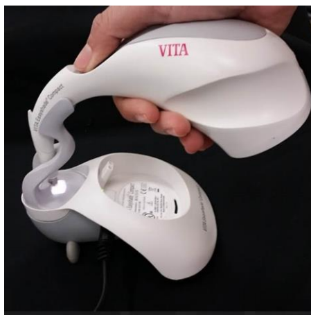
Figura 25. Calibración de espectrofotómetro.
