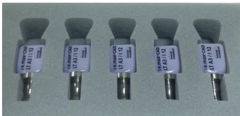
Figura 14. Bloque de Disilicato de Litio, parcialmente cristalizado.
