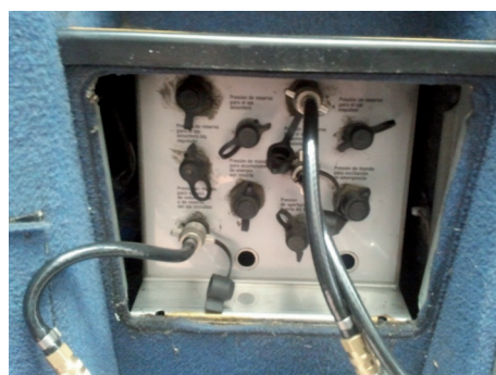
Figura 16: Autobús (tomas de presión centralizadas e identificadas)
