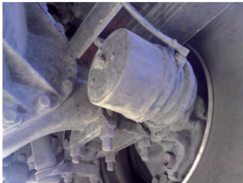
Figura 12: Pulmón de freno sin toma de presión
