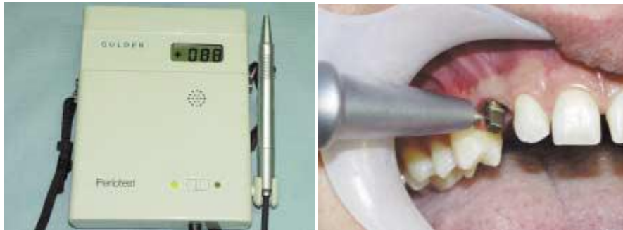
Figura 1. Instrumento Periotest®. La parte activa, perpendicular al eje del implante
