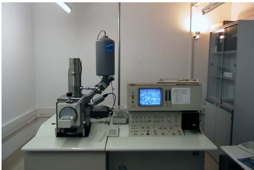
Figura 7.6. Microscopio electrónico de barrido JEOL 6100 con sistema (EDS) Link Isis L-200 X
