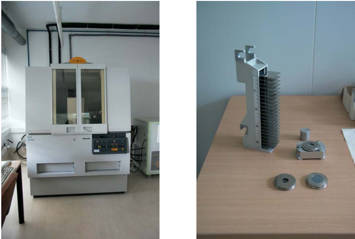
Figura 7.1. a) Difractómetro de RX Philips PW3040, b) Detalle del carro portamuestras, diferentes portamuestras y prensa y pistón utilizados en la preparación de muestras.
