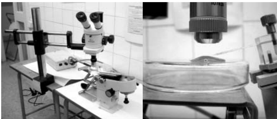
Fotografía 1. Izquierda. Visión de conjunto del sistema de micromanipulación empleado. A la derecha se observa el micromanipulador que lleva fijado el microcapilar. Derecha. Se observa un detalle del sistema de fijación de la raíz.
