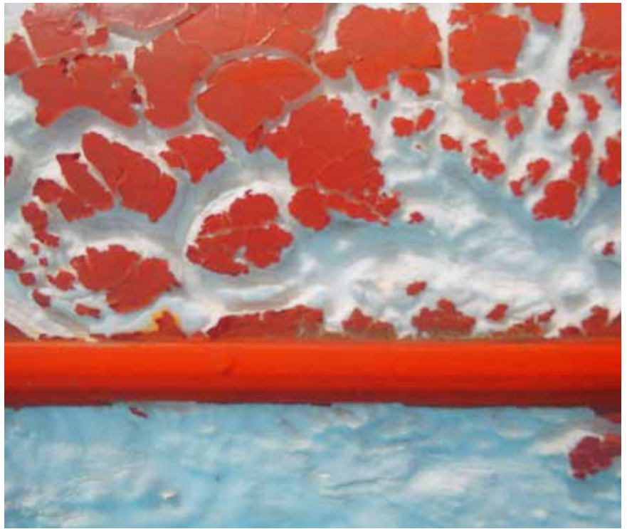
Poliestirè (PS) d'un bot salvavides. Es pot veure la degradació del polímer causada, entre d'altres agents, per l'exposició solar.
