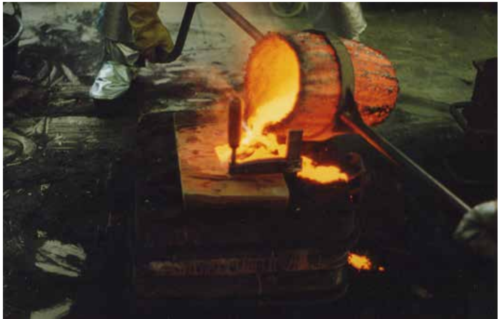
Procés de fundició. En la fotografia s'aprecia l'antic taller de foneria de la Facultat de Belles Arts de Barcelona. Estem posant el motlle amb el model a dins, dins de caixes de ferro reomplertes de sorra de silici, per després abocar-hi el metall fos. 1999.
