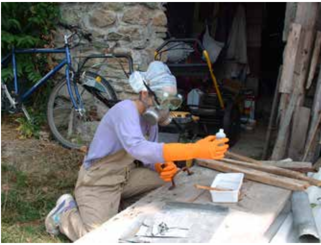
Proporcions de catalitzador, i espàtula de fusta per barrejar la mescla, així apareixen menys bombolles.
