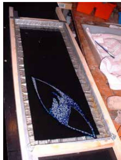
Primera prova del motlle per inclusió. La fusta està recoberta d'una capa de fòrmica. Els límits estan subjectats amb cinta adhesiva. No s'ha fet la prova de resistència a l'acetona. Hi ha cera d'abella líquida com a desemmotllant s'han aplicat uns 250 grams de resina i un primer objecte.
