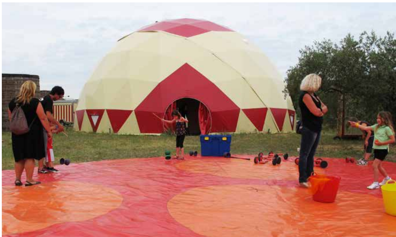
La Tomassa , Cia Passabarret, domo geodèsic, carpa de circ, 2013, ferro galvanitzat i PVC de color reforçat amb teixit de fibra interna.
