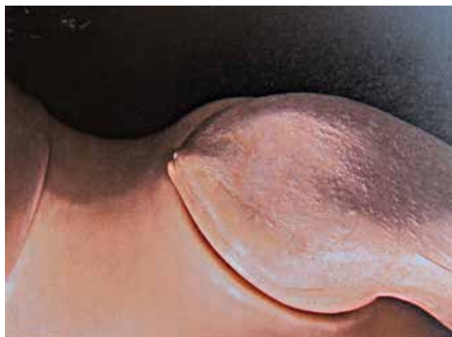
Detall de les ampelles formades al braç d'aquesta nina d'acetat de cel·lulosa. National Museums of Scotland.
