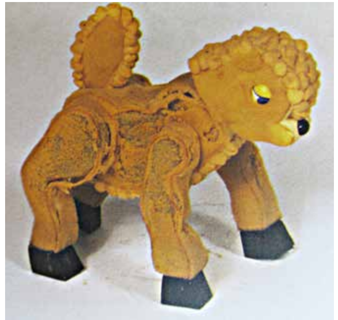
Deteriorament per enfonsament de l'escuma de poliuretà d'aquesta tiella de la telesèrie "Larry the Lamb" de començaments dels 70. Victoria & Albert Museum.
