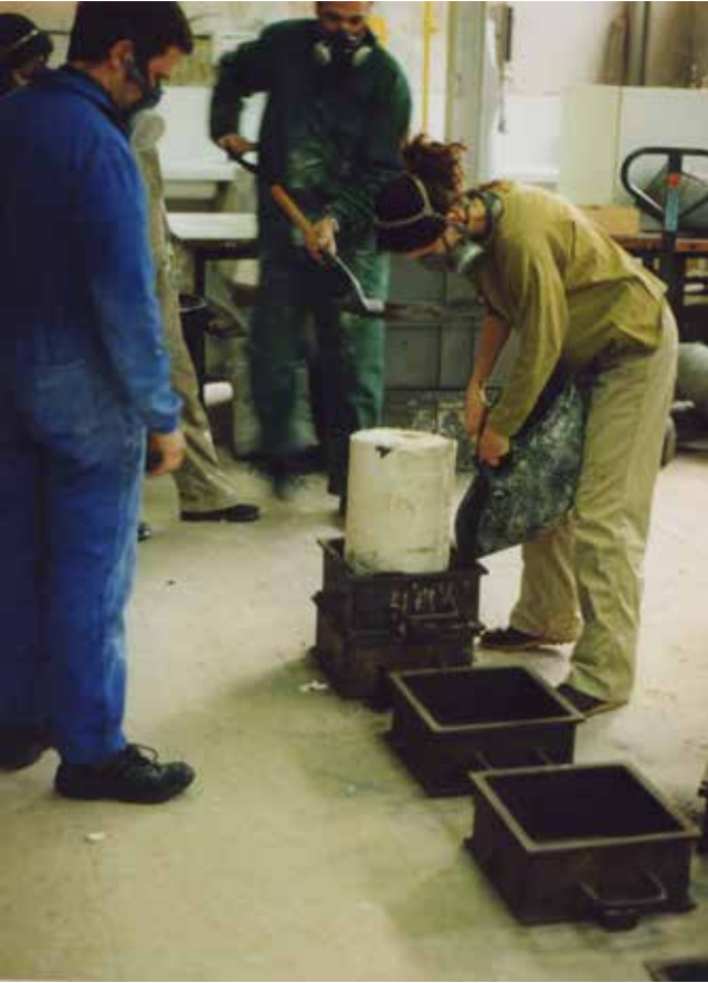
Procés de fundició. En la fotografia s'aprecia l'antic taller de foneria de la Facultat de Belles Arts de Barcelona. Estem posant el motlle amb el model a dins, dins de caixes de ferro reomplertes de sorra de silici, per després abocar-hi el metall fos. 1999.
