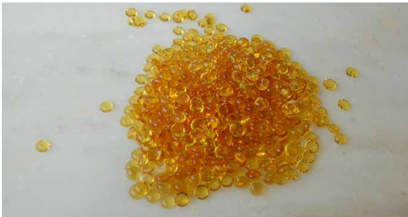
Exemple de gransa, en aquest cas concret es tracta d'una cola termoplàstica, que vaig adquirir en un magatzem de subministres a Atenes, per tal de realitzar experiments de temperatura i adhesió en diferents superfícies.
