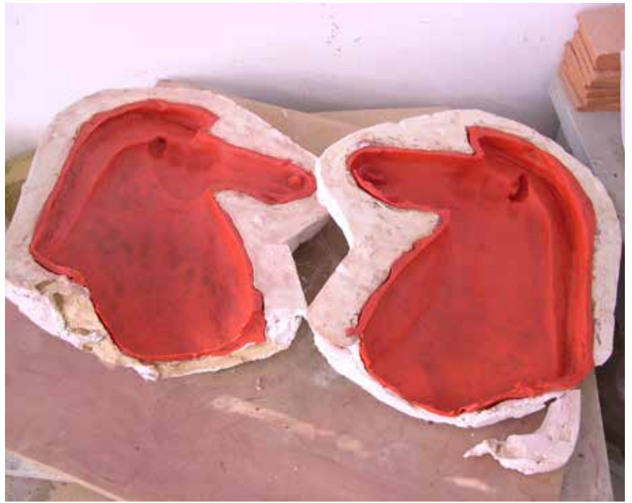
Autor desconegut motlle de guix i Vinamold, per a la reproducció de peces ceràmiques, Atenes 2006.
