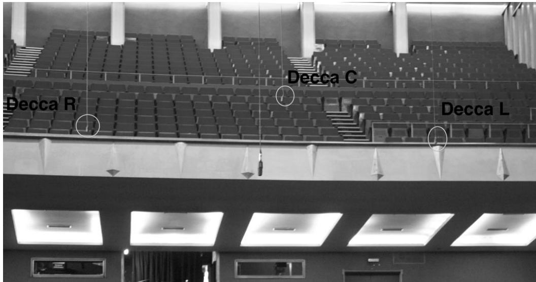
Figura 36 Técnica estéreo DECCA TREE en el Auditorium de Palma con micros suspendidos.
