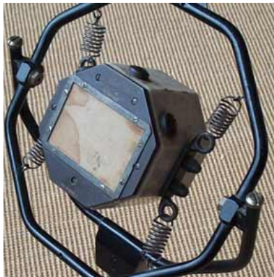
Figura 11 Micrófono Reisz denominado “bloque de mármol” con diafragma de papel de arroz.
