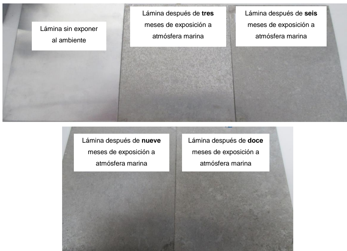
Figura 4.38 Comparación de lámina de aluminio sin exponer y láminas de aluminio expuestas a atmósfera marina durante tres, seis, nueve y doce meses respectivamente
