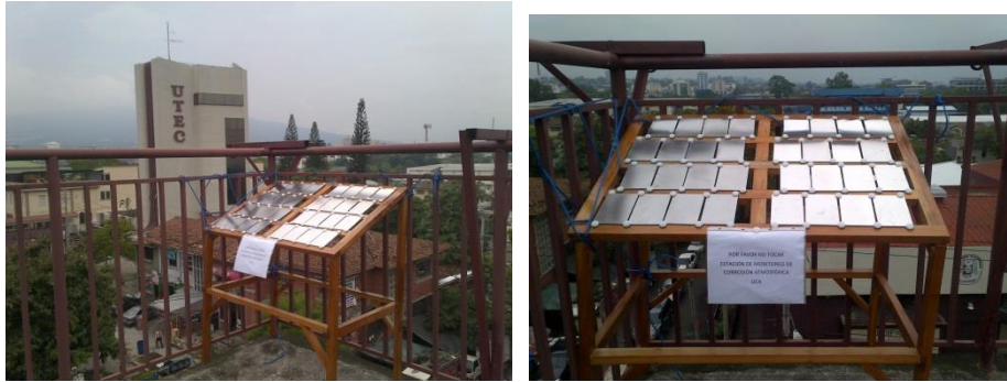
Figura I.8 Rack de monitoreo ubicado en la UTEC
