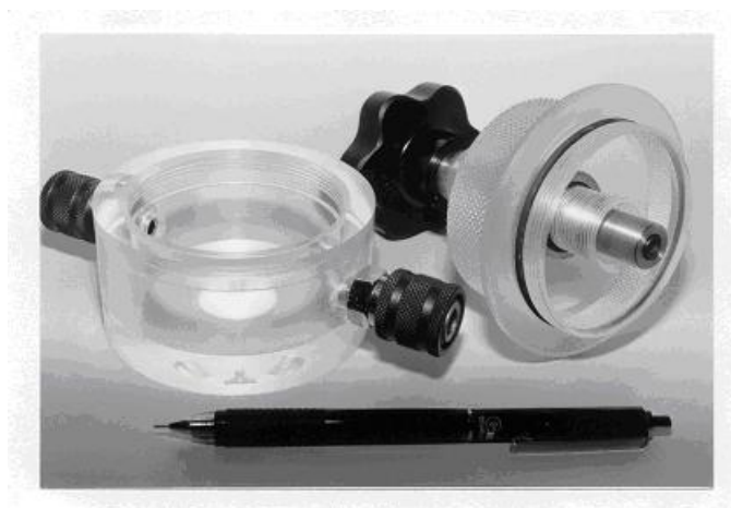
Figura. 2-65 .- Aparato para cerrar crisoles en atmosfera controlada (Cardilo, et al. 1991).
