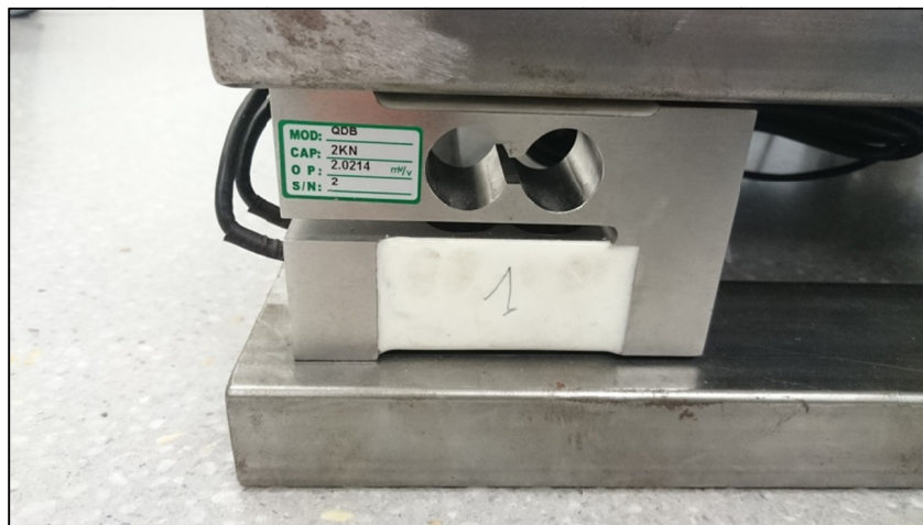
Ilustración 51: Célula de carga biaxial posicionada entre los dos bastidores.
