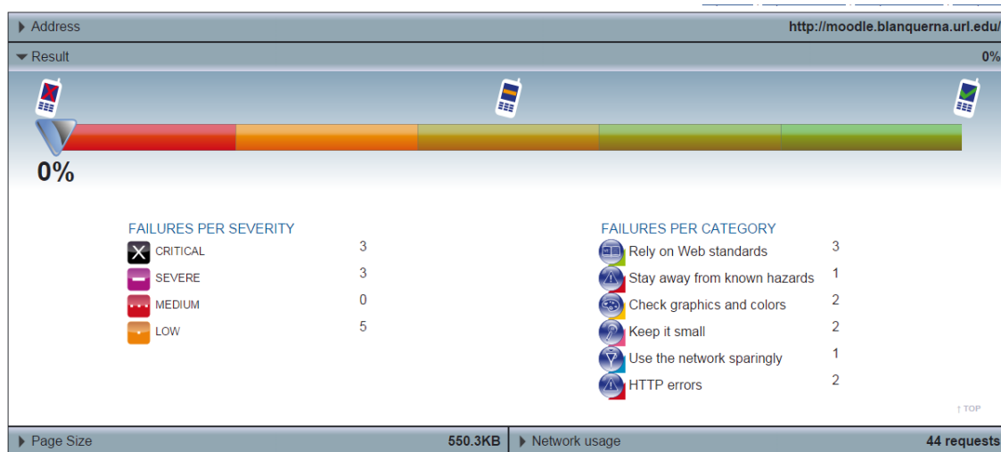
Figura 68. Resultats del validador W3C per a l'adaptació a dispositius mòbils del campus Moodle de Blanquerna. Font: elaboració pròpia
