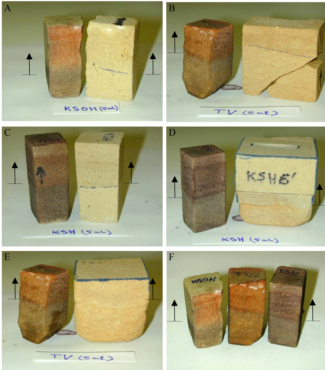
Fig. VIII. 1: (A), (B), (C) Tinción con ditizona, la parte tratada de la muestra se colore en rojo, mientras que la parte no tratada guarda el color original de la solución de ditizona, Se observa también, que el límite marcado por la ditizona coincide con el límite cromatográfico de la penetración del solvente de la solución consolidante. (C) la foto muestra que la coloración con ditizona en el caso del KSH es menos intensa debido a que el producto es una mezcla de silicato de etilo y polisiloxano. (D), (E) el límite de penetración de los consolidantes dado por la ditizona coincide con el límite de alteración obtenido por alteración acelerada con el sulfato sódico. (F) el grado de penetración es casi similar en el caso de los dos consolidantes (izquierda y centro) y también en el caso del producto a doble acción (derecha) para una misma cantidad aplicada.
