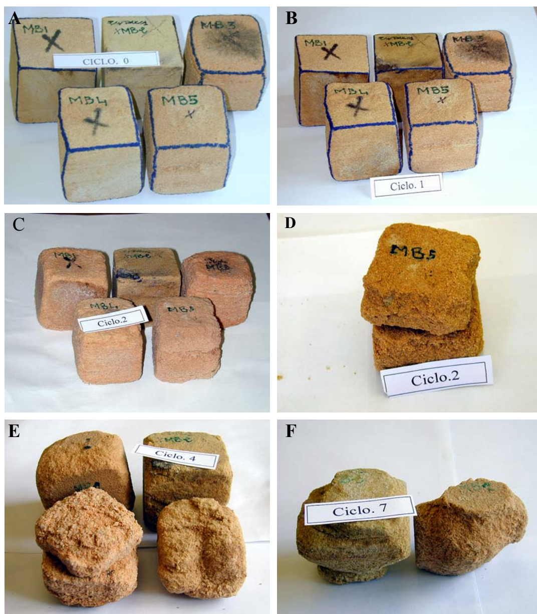
Figura VII.12: Aspecto de las muestras sin tratar durante el ensayo de cristalización de sales. (A) Aspecto de las muestras antes de empezar los ciclos de cristalización de sal. (B) Aspecto intacto de las muestras al finalizar el primer ciclo de cristalización del sulfato sódico (cristalización de tenardita). (C) Aspecto arenizado de las muestras después del segundo ciclo de cristalización de sales (primer ciclo de hidratación de la tenardita). (D) Desplacación de la muestra a favor de la laminación cruzada en el segundo ciclo. (E) Aspecto desmoronado de las muestras con granulometría gruesa y de las de granulometría fina al final del tercer ciclo. (F) Aspecto de las muestras finas (MB1 y MB2) al final del séptimo ciclo de alteración.
