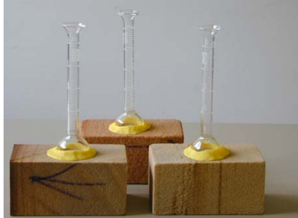
Fig.IV.2. Dispositivo experimental utilizado en el ensayo de absorción de agua a baja presión.
