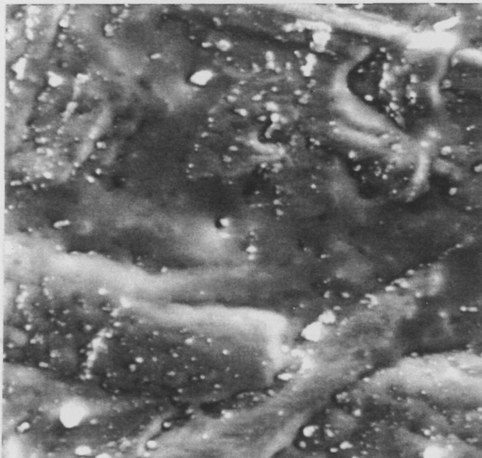
Micrografia 6.2.5. Cinta BE. Tractada 30' a 550°C. Cara en contacte amb la roda (5000 augments).
