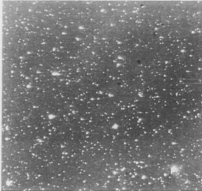
Micrografia 6.2.1. Cinta CF (sense tractar). Cara que no entrà en contacte amb la roda (200 augments).
