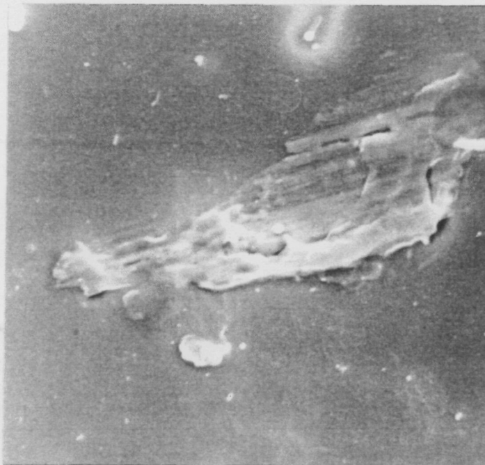
Micrografia 6.2.2. Cinta AD (sense tractar). Cara que no entrà en contacte amb la roda (5000 augments).
