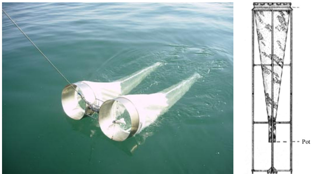
Figura 3.8. Sistema de xarxa bongo per a recollir mostres de zooplàncton (esquerra). Esquema longitudinal d'una de les malles amb el pot de recollida al final (dreta).
