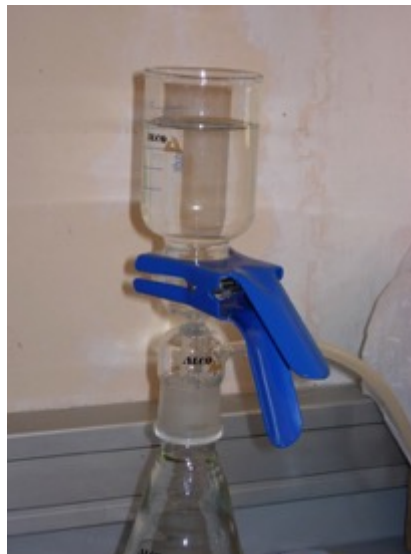
Figura 3.5. Filtrat d'aigua de l'embassament de Flix in situ per obtenir el filtre amb la mostra de fitoplàncton.
