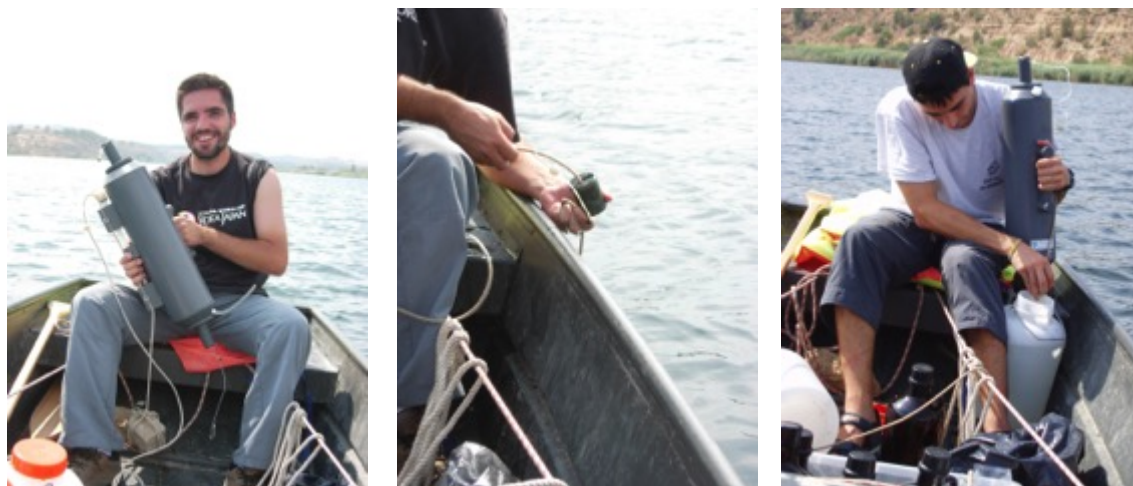
Figura 3.6. Procés de recollida de l'aigua a l'embassament de Flix emprant l'ampolla de Niskin per obtenir el fitoplàncton: preparació de l'ampolla (esquerra); llançament del pes per tancar-la (mig); i traspàs de la mostra als recipients de plàstic (per l'anàlisi de metalls) i de vidre (per COPS) (dreta).
