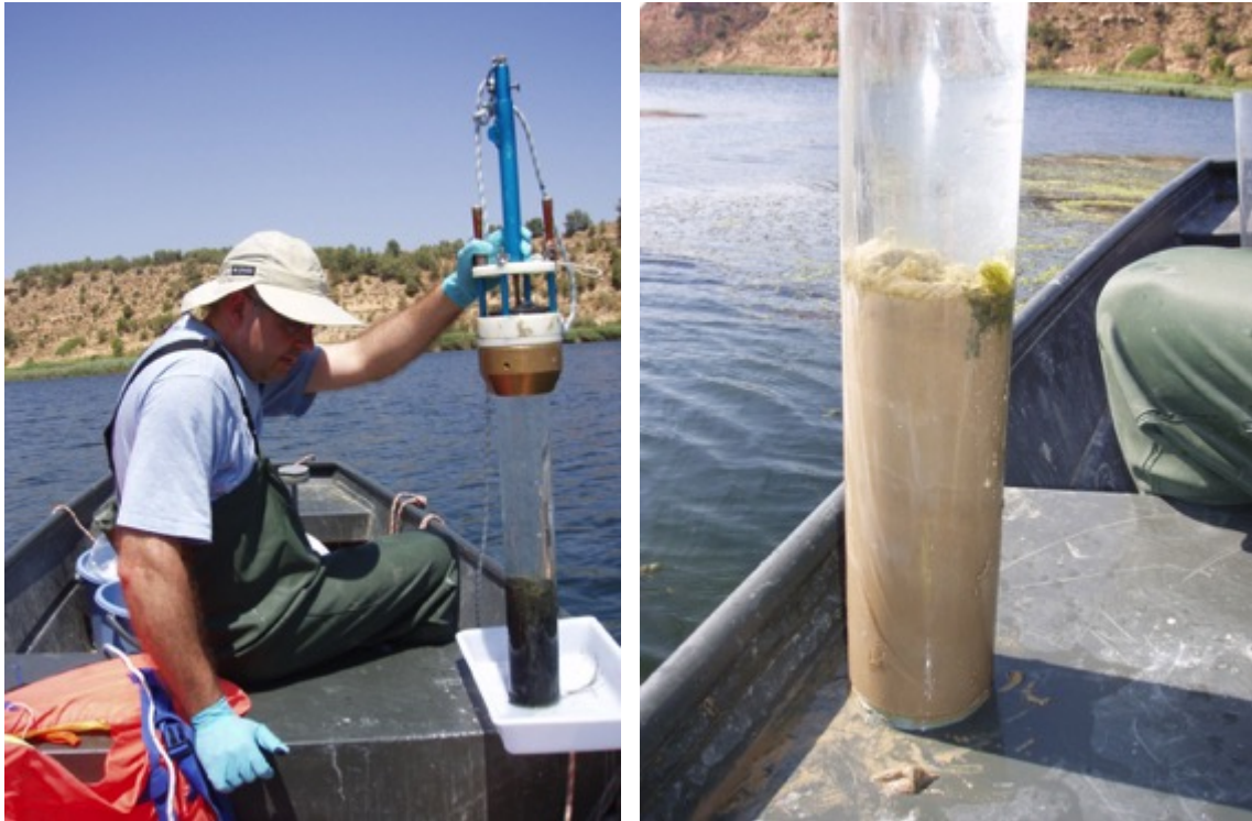
Figura 3.2. Extracció dels cores dins de l'embassament de Flix
