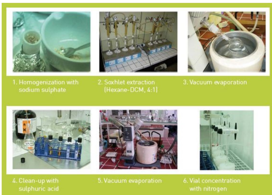
Figura 3.54. Resum gràfic del protocol seguit per realitzar l'extracció de la majoria de mostres biològiques emprant una bateria de Soxhlets.
