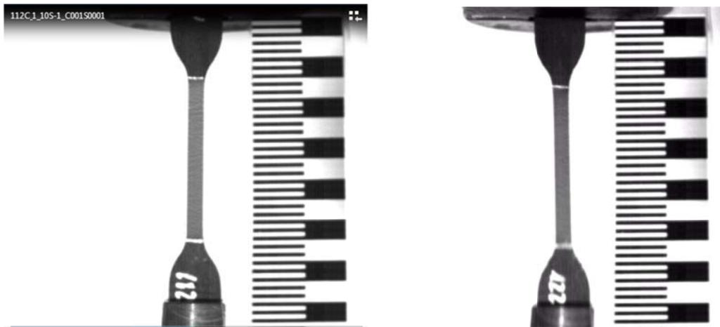
**Figura 8.12:** Fotogramas a una deformación del 20% en probetas con nanofibras ensayadas a: 250mm/s (izquierda) y 2500mm/s (derecha).
