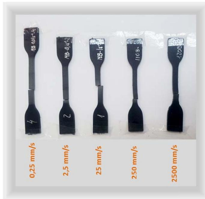
**Figura 8.16:** Fotografía de probetas Scolefin 6% ensayadas a distintas velocidades. Apreciamos la diferencia en la deformación plástica residual y rotura frágil en todos los casos.
