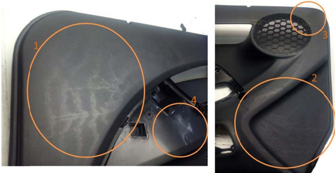
**Figura 10.5:** Defectos en las piezas B inyectadas con Scolefin®.
