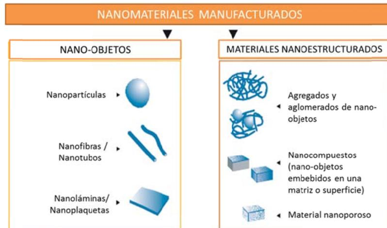
**Figura A. 2:** Clasificación de nanomateriales según ISO TS 80004. Adaptado de [9]
