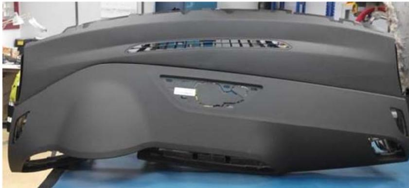
**Figura 10.3:** Prototipo del conjunto montado en el taller de Faurecia para la valoración de los resultados de las pruebas de inyección de la pieza.
