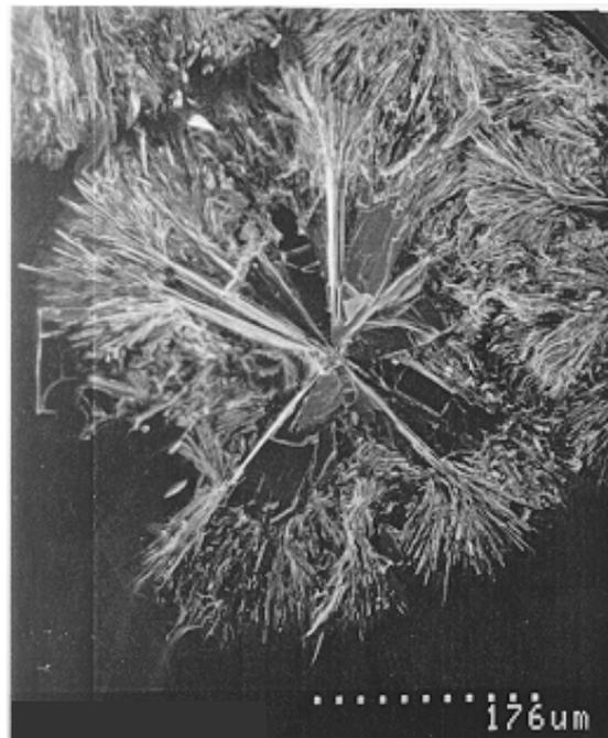
**Fig 7.26:** Estructuras esferulíticas formadas por las lamelas y las fibras agregándose alrededor formando un "cruz".
