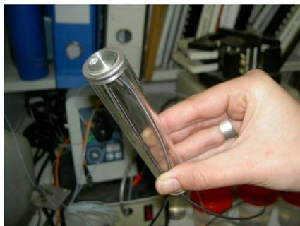
**Figura 3.2.** Sonda de fluorescencia construida.
