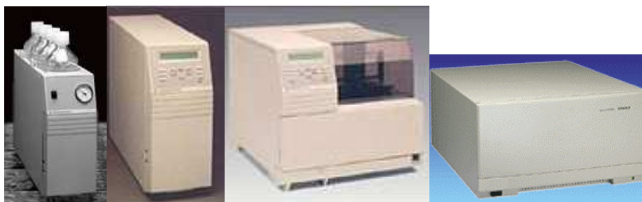
Figura 3.3. Sistema de CLAR Thermo-Fisher. Panel de disolventes y desgasificador “on-line”, panel de bombas de gradiente, automuestreador y detector UV con matriz de diodo.
