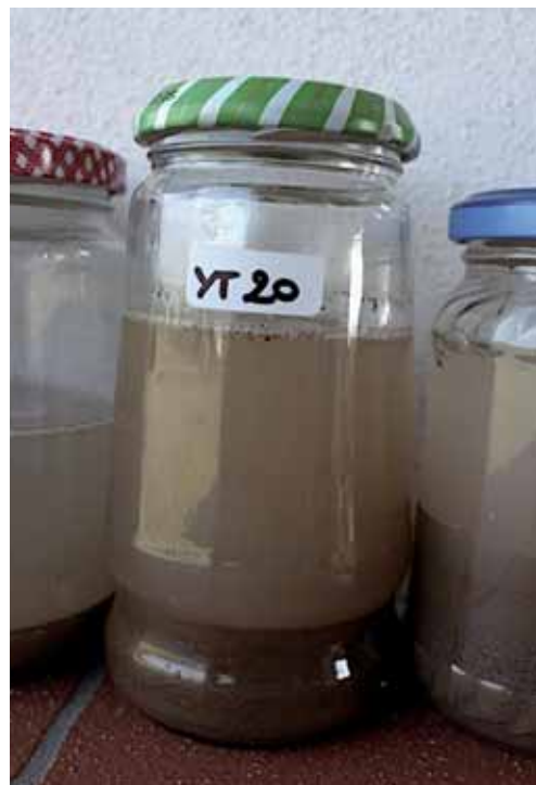
Tavola 10.5 – In questa tavola si osserva il comportamento della terra del campione Y20. Le immagini mostrano il comportamento nella prova di consistenza, ritrazione e sedimentazione. Nella foto in basso a sinistra si osserva il confronto tra le due pasticche ottenute dalle terre di Yumuktepe .
