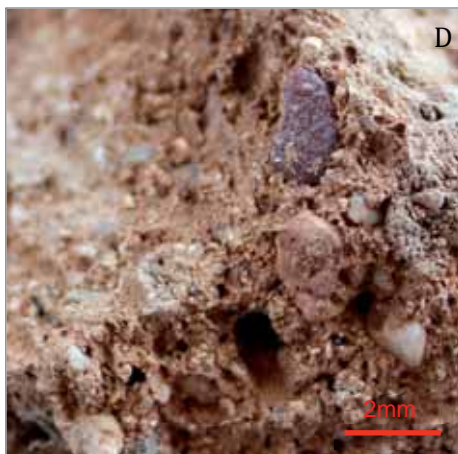
Tavola 8.14 – A-B) In queste foto sono visibili i mattoni calcolitici con colorazione distinta (Scala 1cm). A sinistra i campioni a confronto e a destra le terre analizzate tramite diffrazione raggi X; C) Grafico di comparazione dei diffrattogrammi dei campioni di mattone crudo calcolitico di colore distinto; D-E) In queste due foto si osservano, a sinistra una foto macro del campione di mattone rosso, e a destra una foto macro del campione di mattone bianco.
