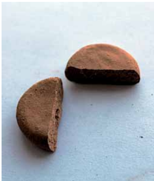
Tavola 10.3 – In questa tavola si osserva il comportamento della terra del campione TH20. Le immagini mostrano il comportamento nella prova di consistenza, coesione, resistenza a secco e sedimentazione.
