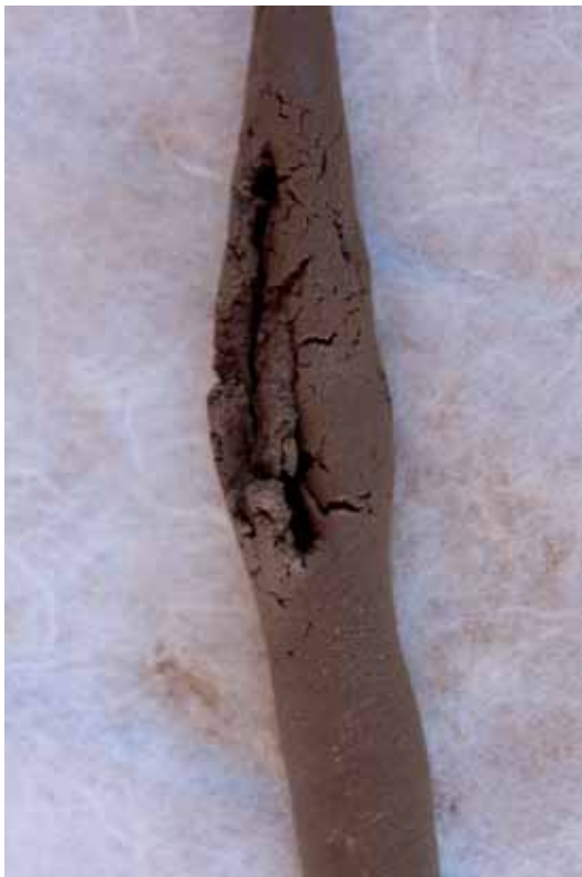
Tavola 10.2 – In questa tavola si osserva il comportamento della terra del campione TH01. Le immagini mostrano il comportamento nella prova di consistenza, ritrazione, coesione e sedimentazione.
