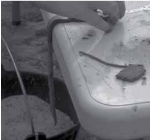
Fig.10.5 - In questa foto si può osservare la lunghezza del nastro ottenuto che determina una terra con molta argilla.
