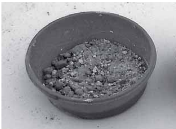
Fig. 10.3 – La terra con caratteristiche migliori per costruire come si può osservare dalla foto è una mistura di elementi, quali: sabbia, noduli di argilla e ghiaia di piccole dimensioni.
