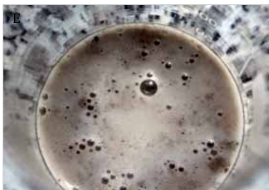
Tavola 8.1 – A) Polverizzazione campione tramite mortaio in agata; B) Montaggio della polvere nel porta campione; C) Campioni montati su maschera grande (15); D) Diffratometro X'Pert Philips; E) Reazione di effervescenza causata dallo scioglimento dei carbonati; F) Ultimo passaggio prima della raccolta tramite pipetta della sospensione argillosa.
