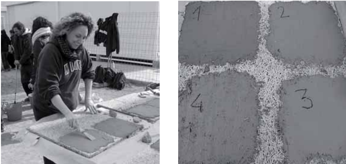
Fig. 10.11– In queste due foto si vedono l'applicazione del rivestimento a destra e i quattro distinti impasti stesi a sinistra.
