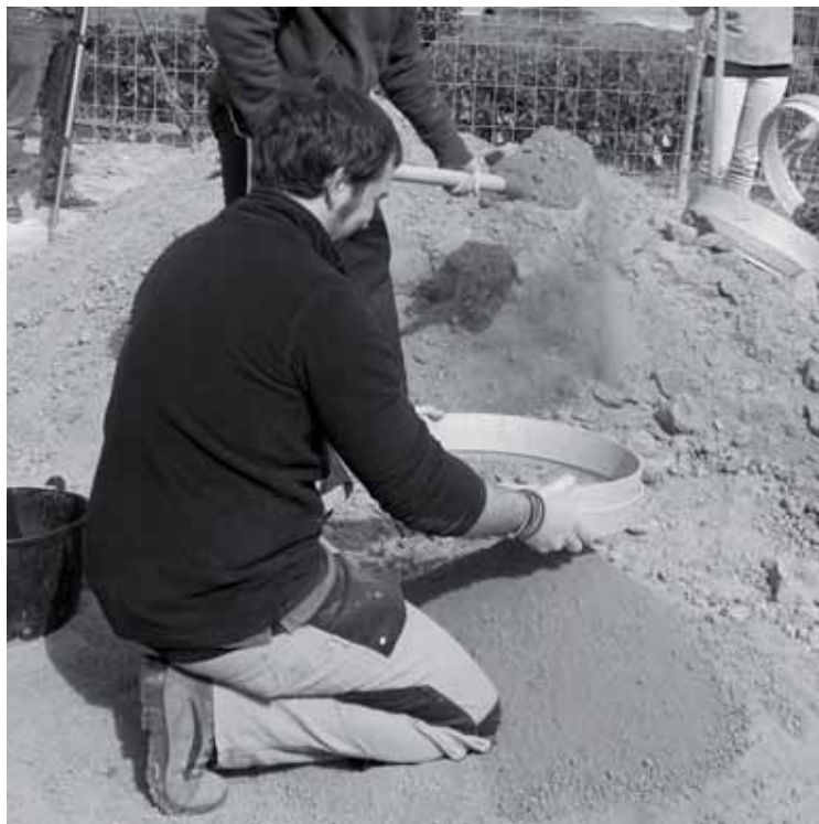
Fig. 10.6 – In questa foto si può osservare la setacciatura della terra proveniente dal mucchio che è caratterizzata da una granulometria grossolana e il prodotto ottenuto attraverso il setaccio che presenta una granulometria più fine.
