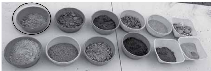
Fig. 10.1 – Le terre proposte tra cui i partecipanti hanno scelto le più valide per la costruzione; quella cerchiata è quella più buona.
