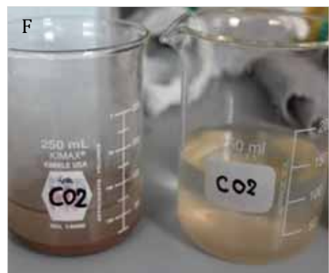
Tavola 8.1 – A) Polverizzazione campione tramite mortaio in agata; B) Montaggio della polvere nel porta campione; C) Campioni montati su maschera grande (15); D) Diffratometro X'Pert Philips; E) Reazione di effervescenza causata dallo scioglimento dei carbonati; F) Ultimo passaggio prima della raccolta tramite pipetta della sospensione argillosa.
