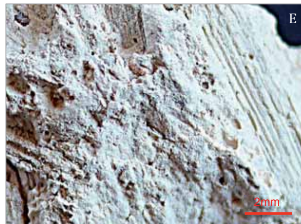
Tavola 8.14 – A-B) In queste foto sono visibili i mattoni calcolitici con colorazione distinta (Scala 1cm). A sinistra i campioni a confronto e a destra le terre analizzate tramite diffrazione raggi X; C) Grafico di comparazione dei diffrattogrammi dei campioni di mattone crudo calcolitico di colore distinto; D-E) In queste due foto si osservano, a sinistra una foto macro del campione di mattone rosso, e a destra una foto macro del campione di mattone bianco.
