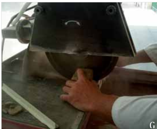
Tavola 9.1 – A-B) Foto del laboratorio dell’Università di Ingegneria di Siviglia; C) Stufa di essiccamento; D) Recipiente collegato a pompa per portare i campioni in sotto vuoto prima dell’inserimento del liquido; E) Pesata del campione saturo; F) I quattro campioni di Tell Halula su cui sono state effettuate le prove fisico-meccaniche; G) Sega circolare per tagliare i provini cubici; H) I provini cubici ottenuti dai campioni esaminati che potevano essere analizzati.
