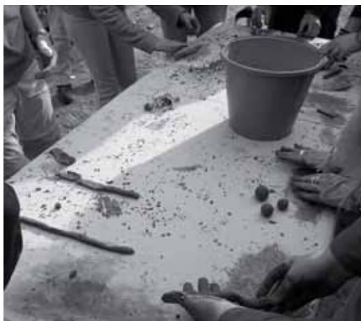
Fig.10.4– In questa foto si osservano i partecipanti che lavorano la terra formando le palline, i cordoni e i nastri.
