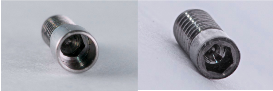
Fig. 70: Tornillo prototipo 3 íntegro (izquierda) y tornillo prototipo 3 una vez fracturado y extraído del implante.
