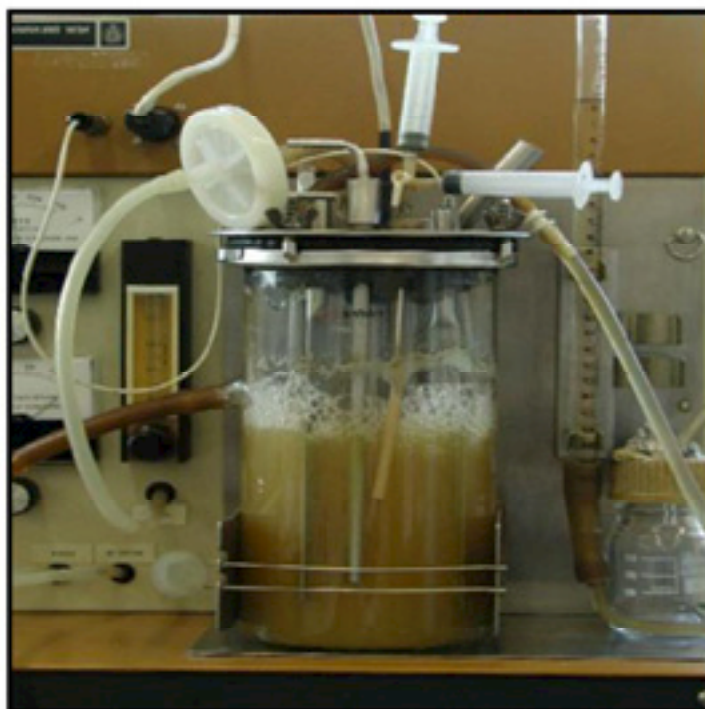
Figura 5.1. Bioreactor utilizado para llevar a cabo las fermentaciones, de donde se extrajeron las muestras utilizadas para construir los modelos multivariados.
