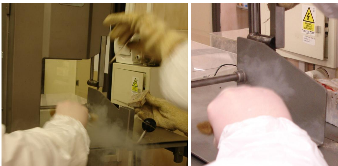
Fig. 3.8- Impregnación de la sierra con nitrógeno líquido durante la realización de los cortes.
