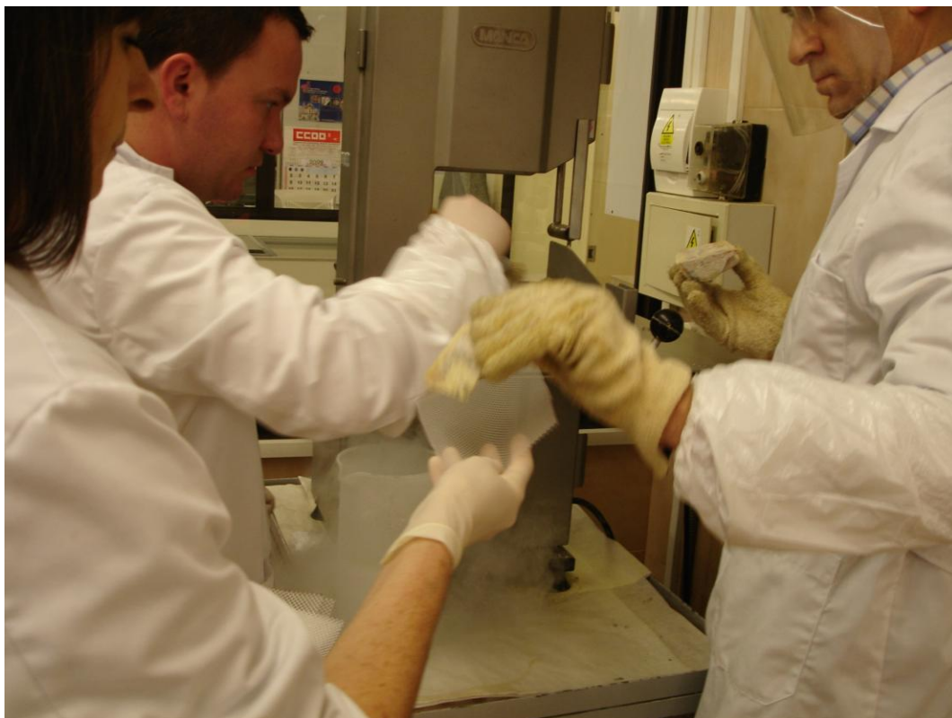
Fig. 3.9- Colocación del corte realizado en rejillas para traspararlo al baño de acetona.
