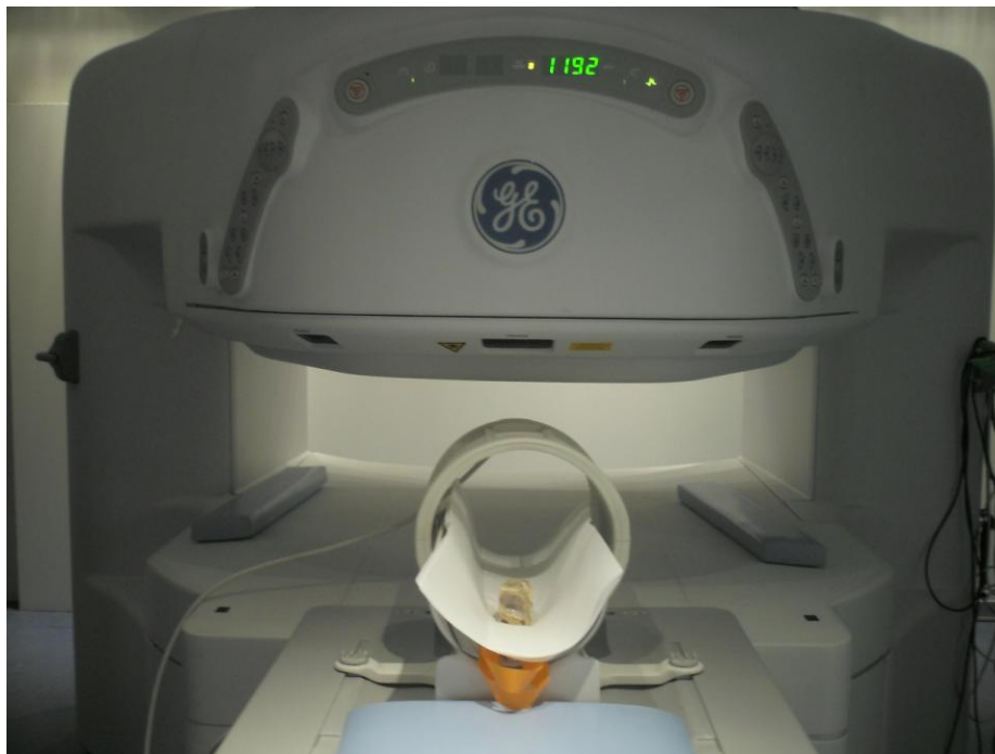
Fig. 3.2- Aparato de RM en el que se realizó el estudio de imagen de las piezas de ATM.
