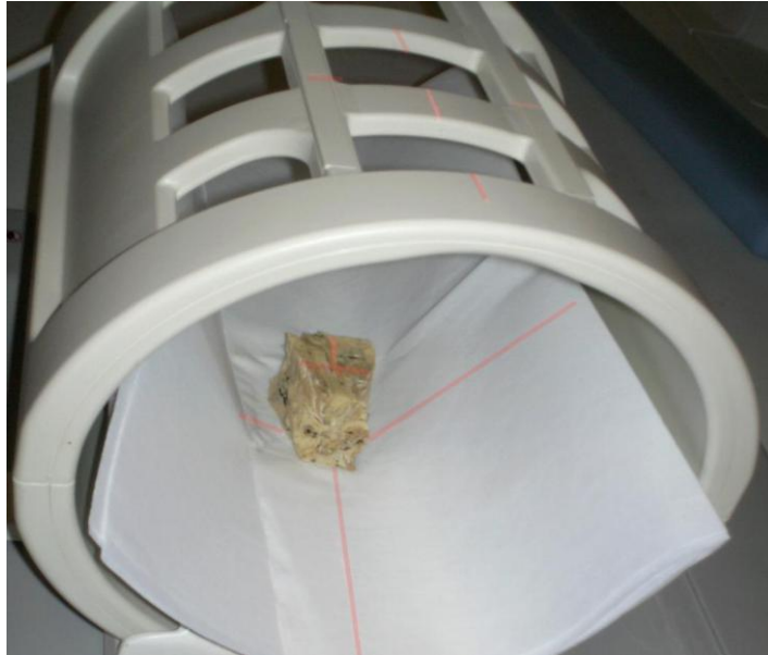
Fig. 3.3- Pieza 4A colocada en posición anatómica en el interior de la bobina del aparato de RM, se observan los haces de luz proyectados por el aparato de RM para centrar la pieza en la adquisición de imágenes.
