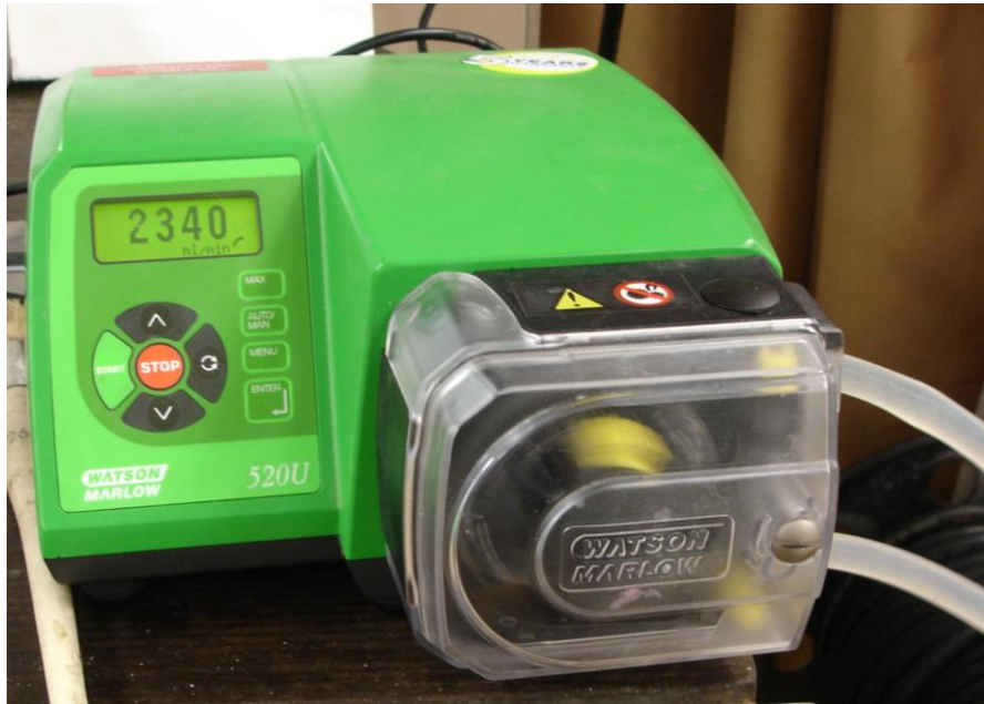
Fig. 3.11- Bomba peristáltica utilizada para perfundir acetona durante la limpieza de los cortes.
