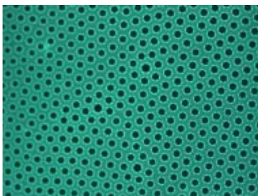
Fig. 3.12. Reconstrucción óptica 3-D obtenida por en películas de Alq 3 /policarbonato por microscopía óptica confocal.
