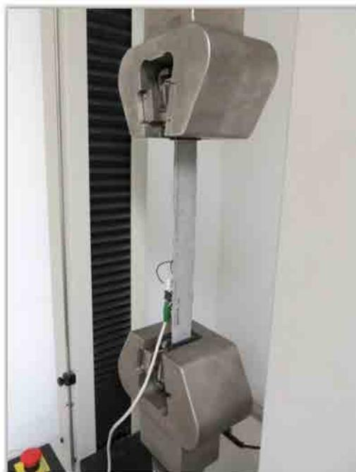
**Figura A.84 Posición inicial del ensayo a tracción de probetas de *TRM*.**
