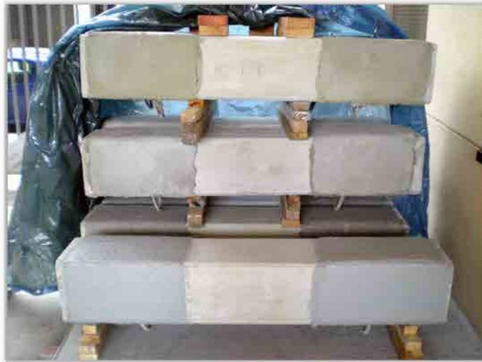
Figura D.7 Vigas V durante la fase de curado de los refuerzos.
