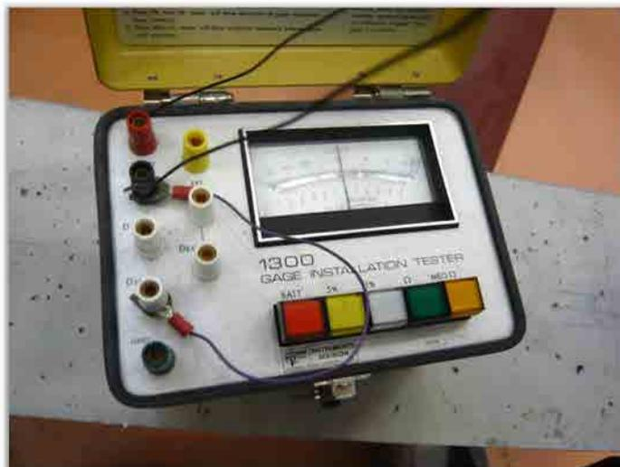
**Figura B.11** Verificador utilizado para la comprobación de las galgas extensométricas instaladas.
