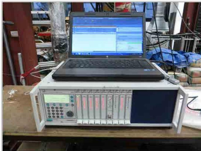
**Figura D.13 Adquisidor de datos HBM MGCPlus.**
