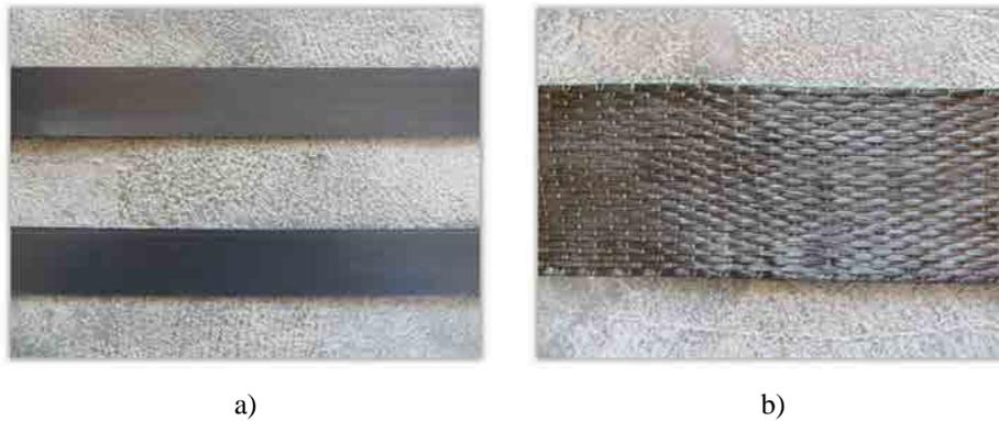
Figura 2.12 Tipologías de *FRP*: (a) sistema precurado, (b) sistema de curado *in situ*.
