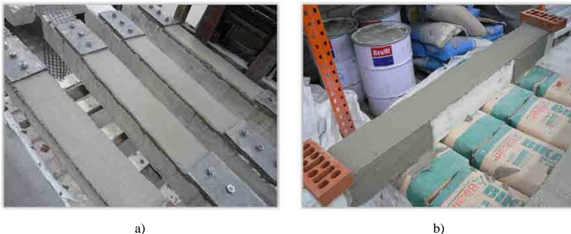
**Figura 2.33 Anclajes mecánicos utilizados por Larrinaga *et al.* a) placas atornilladas [67], b) encamisados parciales de *TRM* [68].**
