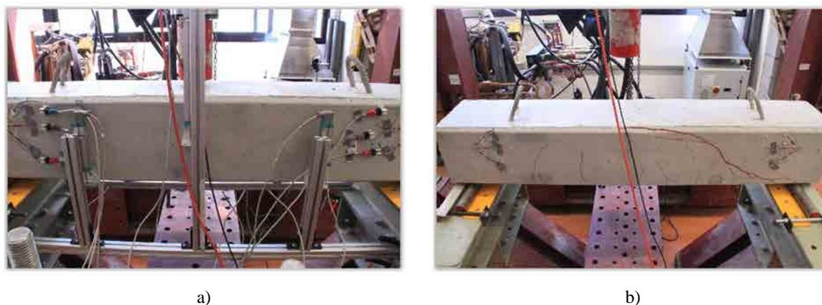
**Figura D.16 Ensayo viga V-CONTROL: a) inicio del ensayo, b) final del ensayo.**
