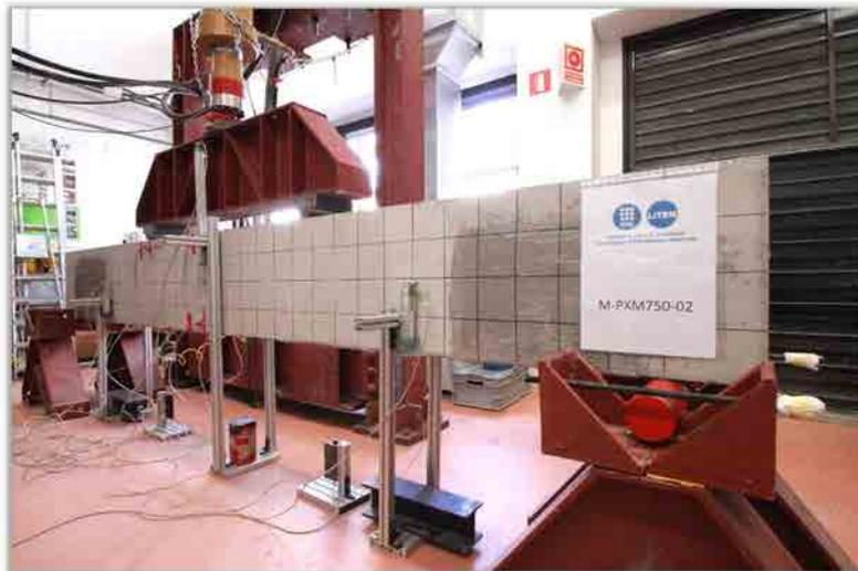
Figura C.84 Ensayo de la viga M-PXM750-02.
