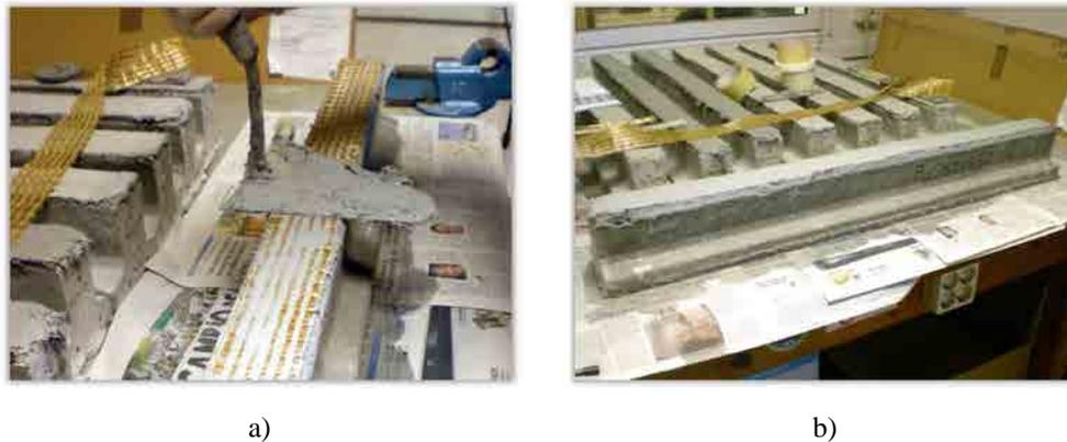
Figura B.5 Aplicación del *TRM* en las viguetas: a) imbibición del tejido en la matriz, b) vigueta reforzada en fase de curado.
