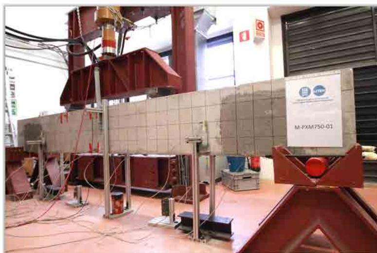
Figura C.77 Ensayo de la viga M-PXM750-01.
