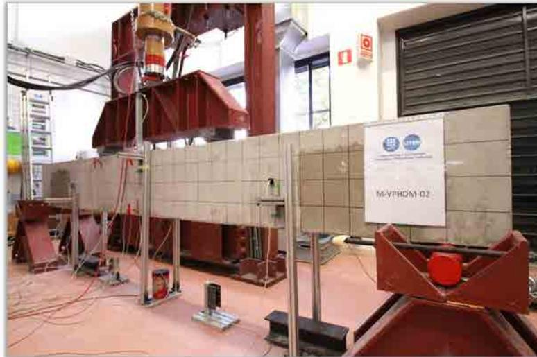
Figura C.99 Ensayo de la viga M-VPHDM-02.
