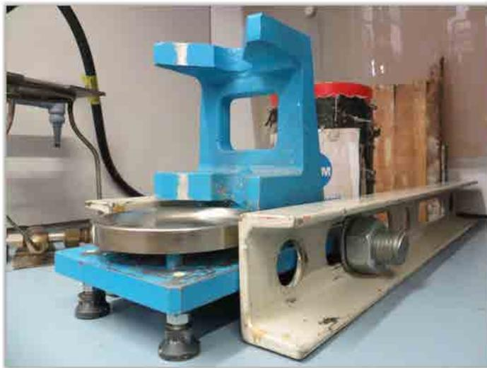
**Figura A.2 Molde normalizado utilizado en el proceso de refrentado de las probetas de hormigón.**
