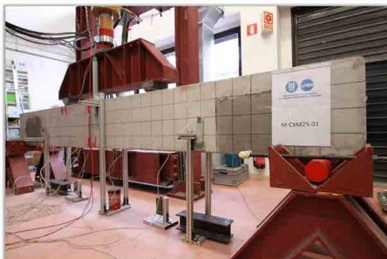
Figura C.62 Ensayo de la viga M-CXM25-01.
