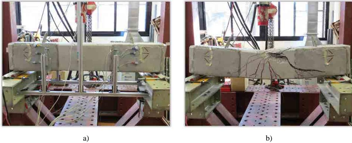
Figura D.24 Ensayo viga V-BR3-02: a) inicio del ensayo, b) final del ensayo.
