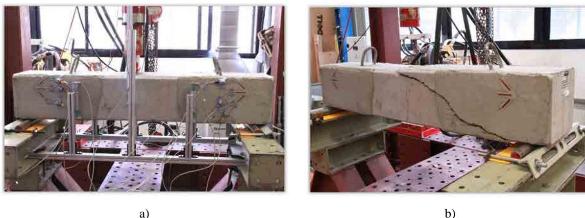
**Figura D.44 Ensayo viga V-VPHDM-01: a) inicio del ensayo, b) final del ensayo.**
