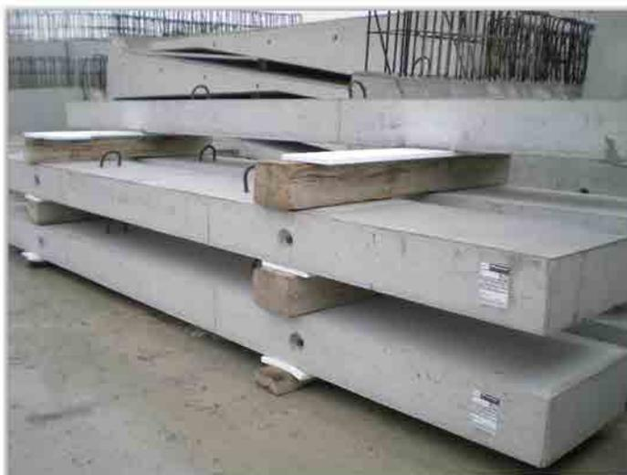
Figura C.4 Vigas M terminadas y en fase de curado.
