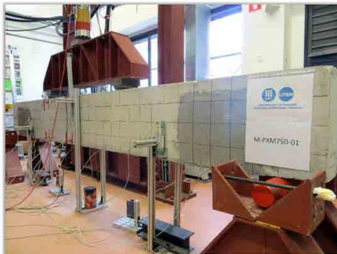
Figura C.22 Estado inicial previo a la aplicación de la carga en los ensayos de vigas M reforzadas a flexión con TRM.
