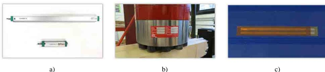
**Figura D.10 Sensores utilizados en los ensayos de las vigas V: a) potenciómetros Waycon LWR-500 y Waycon LWR-100, b) célula de carga AEP CTC416550T5, c) galga extensométrica HBM 1-LY41-50/120.**
