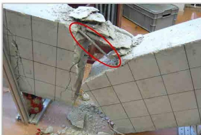
Figura A.17 Armadura longitudinal de una de las vigas de hormigón reforzadas a flexión con *TRM* utilizada como probeta de ensayo.
