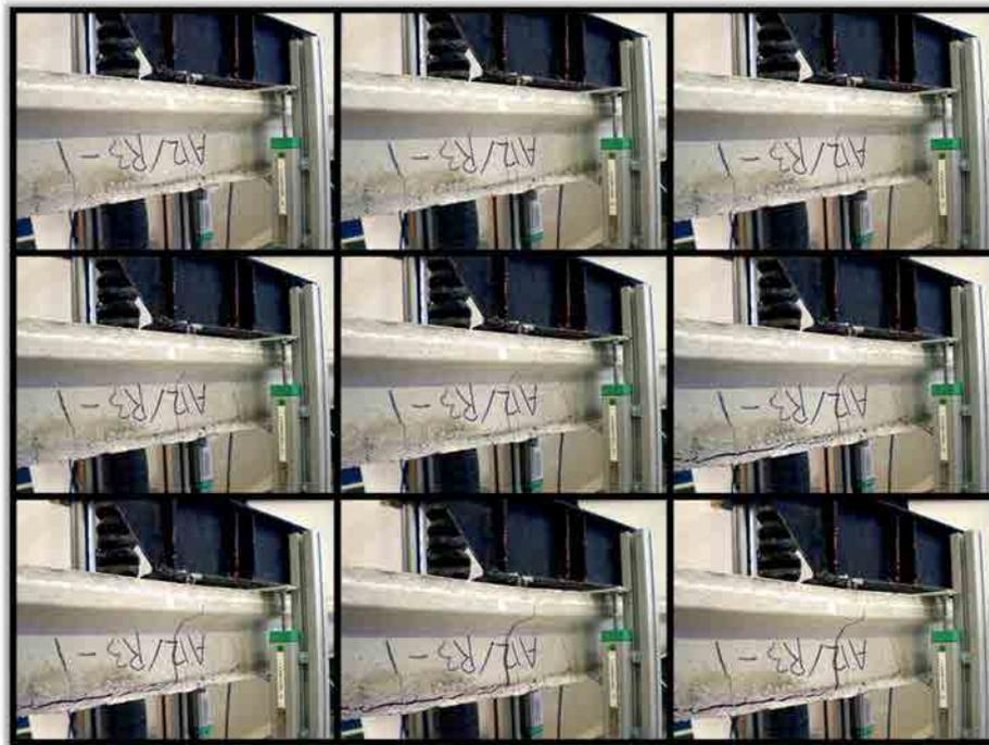
Figura B.15 Proceso de rotura de una vigueta reforzada con *TRM* tipo A12R3.
