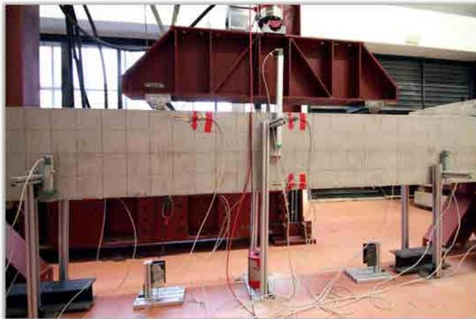
**Figura C.17** Imagen de los sensores utilizados en los ensayos de las vigas M.
