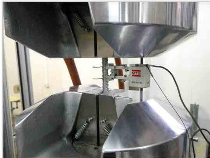
Figura 3.2 Ensayo realizado en barras corrugadas de acero.
