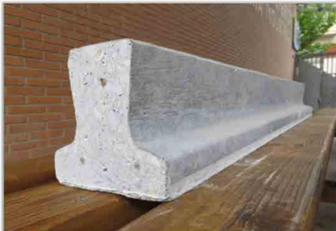
Figura B.1 Tipología de vigueta prefabricada de HA pretensada ensayada.
