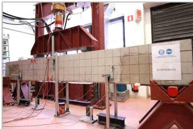
Figura C.92 Ensayo de la viga M-VPHDM-01.
