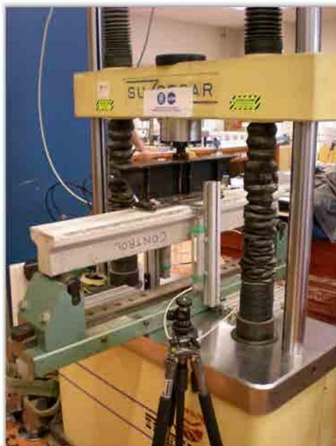
Figura B.7 Montaje del ensayo a flexión de viguetas reforzadas con *TRM*.
