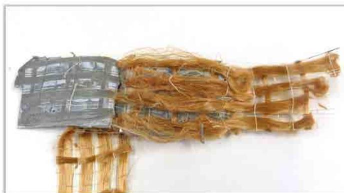
**Figura A.65** Impregnación deficiente del adhesivo en tejido de *PBO*.
