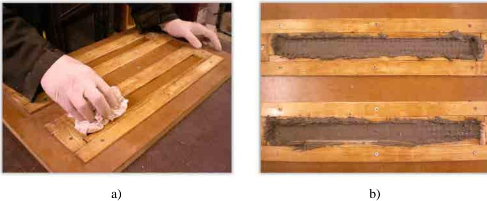
**Figura A.79** Preparación de las probetas de TRM: a) impregnación del encofrado con líquido desencofrante, b) tejido embebido en la primera capa de mortero.
