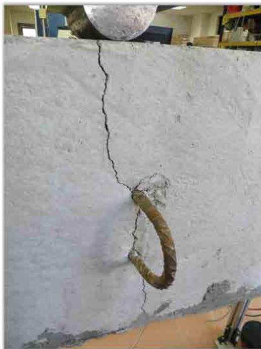
**Figura C.63 Fisura aparecida durante el proceso de desmoldeo de la viga M-CXM25-01.**
