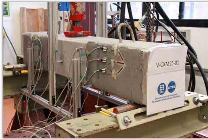
**Figura D.14** Estado inicial previo a la aplicación de la carga en los ensayos de vigas V reforzadas a cortante con *TRM*.
