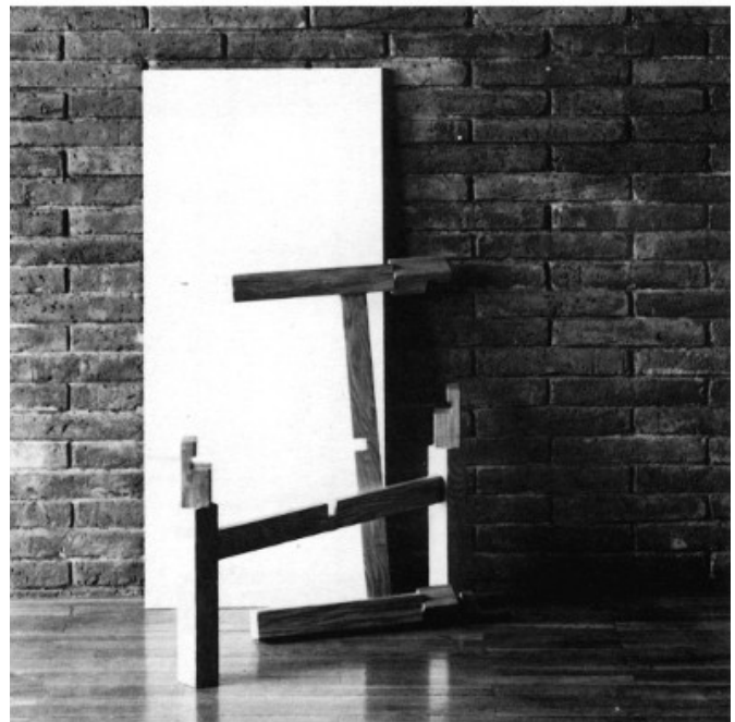
Il·lustració 16: Taula desmuntable 100x47x41cm. Fusta. Les potes es munten mitjançant un encaix central i el sobre es subjecta a través d'unes peces que actuen a mode de guia (1957). Moragas i Gallissà [UPC 1991, p. 54]
