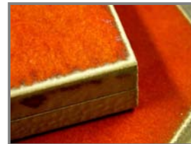
Piezas para la cubierta del mercado de Santa Catalina (Miralles – Tagliabue), en la boca de salida de la extrusora (13)
