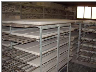
Secadero horizontal de piezas de gres extrudidas para fachadas ventiladas (Taller Toni Cumella)
