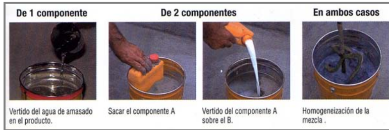
Mortero cola de uno y dos componentes (Guía de productos Sika®)
