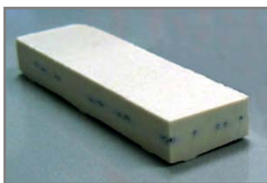
Probeta para los ensayos de resistencia: aspecto de los bordes luego del corte.
