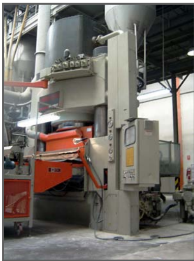
Prensa hidráulica para el prensado piezas de grandes dimensiones de gres porcelánico y salida de las piezas prensadas.
