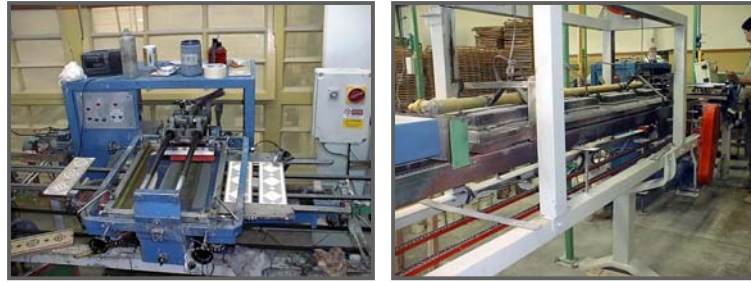
Máquina para aplicación de serigrafías - Secaderos por aire caliente de piezas serigrafiadas
