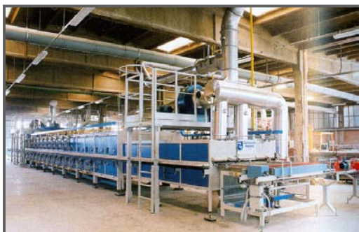
Horno para cocción del 3º fuego Fábrica de Gambarelli Impianti .
