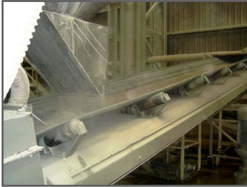
Polvos de atomizado a la salida del atomizador
