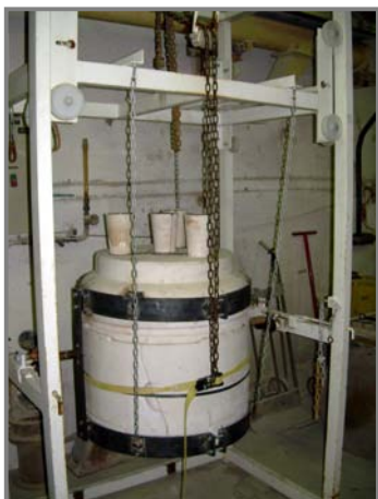
Máquina para moldeado por colado con cuerpo de yeso Pieza conformada por colado para la restauración de la Sagrada Familia (Taller Cerámica Cumella)
