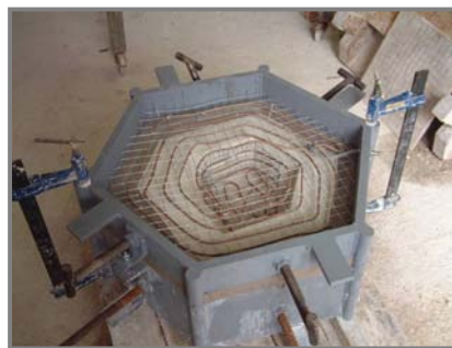
Prensa y molde con circuito de aire para desmoldar, para el conformado de las piezas utilizadas en el Pabellón de España (A. Zaera) en Aichi (2005).
