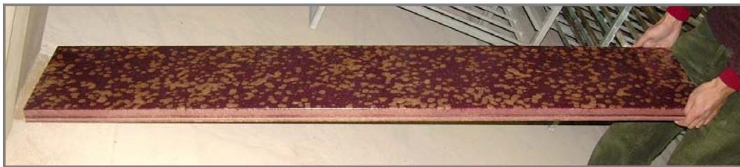
Pieza de gran formato extrudida del Taller Cumella, esmaltada, de monococción, de 1,70 x 36 m. Para uso en fachadas ventiladas. Foto: María Celina Vacca en Taller Toni Cumella.
