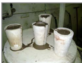
Máquina para moldeado por colado con cuerpo de yeso Pieza conformada por colado para la restauración de la Sagrada Familia (Taller Cerámica Cumella)
