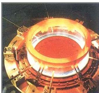
Motor de avión: CMC después del quemado durante el ensayo del motor
