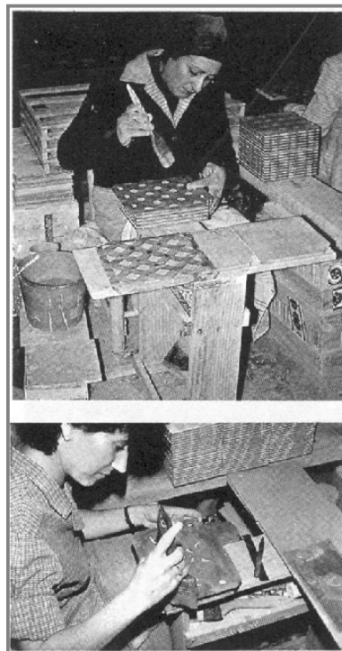
Balsas de esmalte y esmaltado manual Fábrica Piñón y Ribes, Onda, Castellón
