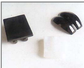
Prótesis de tobillo con revestimiento cerámico
