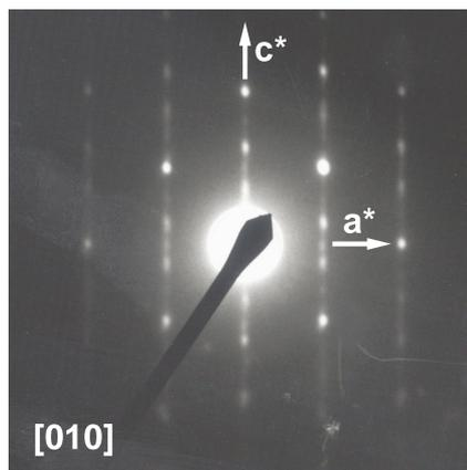
Figura 5.10. Difracción de electrones a lo largo de los ejes de zona  $[001]$  y  $[010]$  de  $\text{Sr}_3\text{Ta}_2\text{O}_5\text{N}_2$ .
