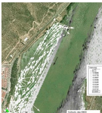
Figura 58 Detalle del campo de vectores de velocidad para un caudal de 100 \text{ m}^3/\text{s} en el río Segre y una aperturas de 10 m.
