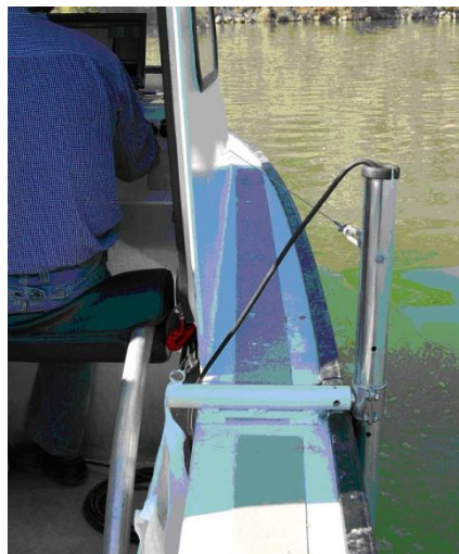
Figura 25. Ecosonda multihaz instalada en la embarcación. Campaña batimétrica 2007.
