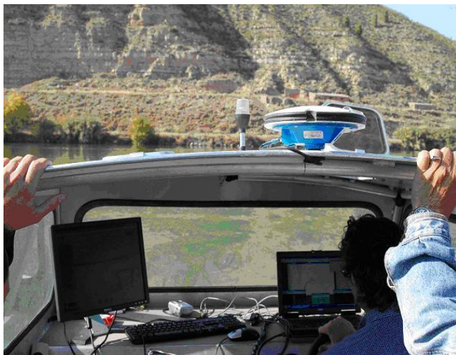
Figura 24. Sensor GPS instalado en la barca de navegación.
