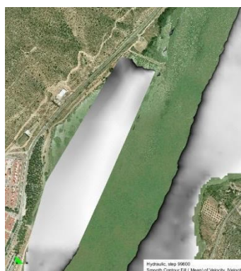
Figura 57 Detalle del campo de velocidades para un caudal de 100 \text{ m}^3/\text{s} en el río Segre y una apertura de 30 m. Valores en m/s.
