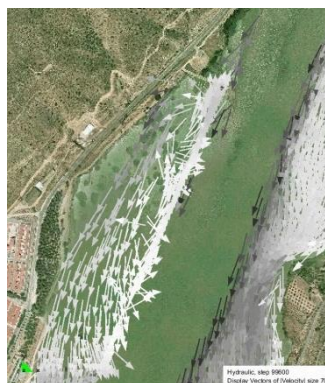
Figura 59 Detalle del campo de vectores de velocidad para un caudal de 100 \text{ m}^3/\text{s} en el Segre y una aperturas de 30 m
