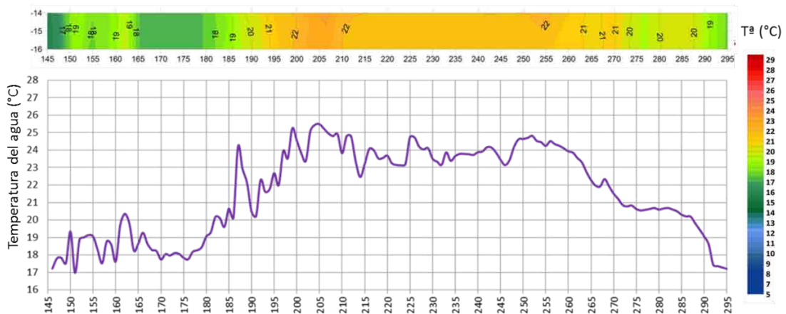
Figura 102. Año 2010. Gráfico superior: evolución térmica del embalse a 15 m de profundidad en la plataforma Flumen (datos cada 6 h, interpolados). Gráfico inferior: evolución térmica del embalse a 15 m de profundidad simulados por el modelo CE-QUAL-W2 (segmento 58, capa a 15 m de profundidad).
