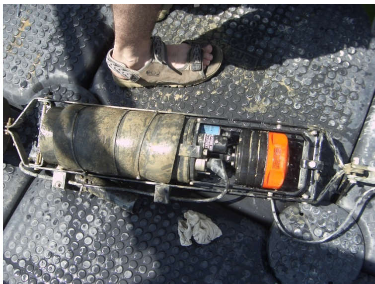
Figura 20. Sonda multiparamétrica AANDERAA RCM-9 instalada en la plataforma Flumen. Se pueden apreciar algunos de los sensores montados en la sonda.
