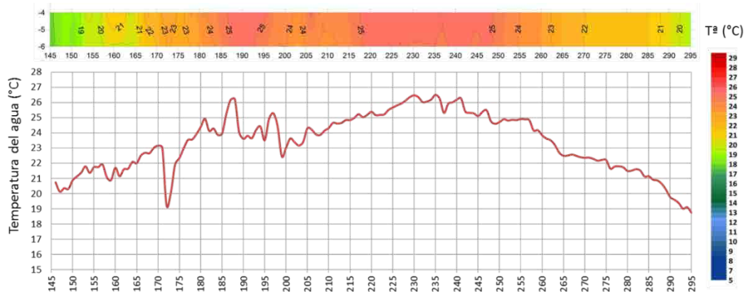
Figura 91. Año 2009. Gráfico superior: Evolución térmica del embalse a 5 m de profundidad en la plataforma Flumen (datos cada 6 h, interpolados). Gráfico inferior: Evolución térmica del embalse a 5 m de profundidad simulados por el modelo CE-QUAL-W2 (segmento 58, capa a 5 m de profundidad).
