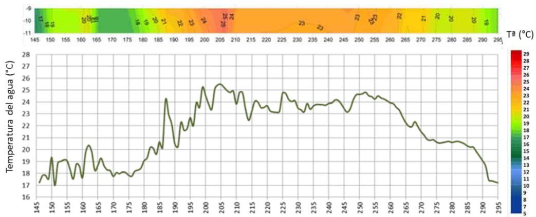
Figura 101. Año 2010. Gráfico superior: evolución térmica del embalse a 10 m de profundidad en la plataforma Flumen (datos cada 6 h, interpolados). Gráfico inferior: evolución térmica del embalse a 10 m de profundidad simulados por el modelo CE-QUAL-W2 (segmento 58, capa a 10 m de profundidad).
