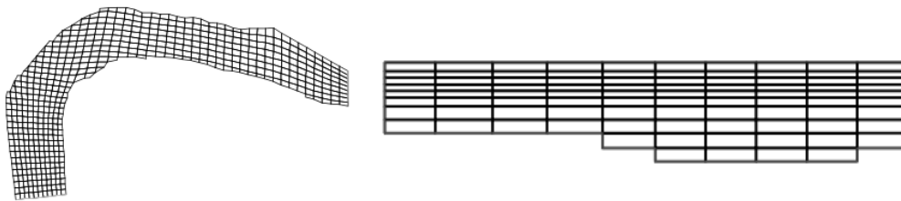
Figura 123. ejemplo de malla no estructurada en el plano (izquierda) y de malla estructurada en la vertical (derecha).
