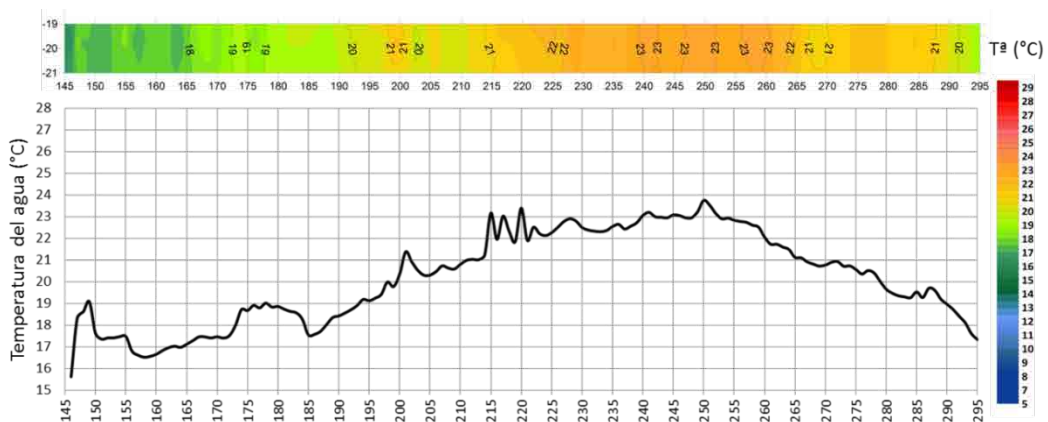
Figura 94. Año 2009. Gráfico superior: evolución térmica del embalse a 20 m de profundidad en la plataforma Flumen (datos cada 6 h, interpolados). Gráfico inferior: evolución térmica del embalse a 20 m de profundidad simulados por el modelo CE-QUAL-W2 (segmento 58, capa a 20 m de profundidad).
