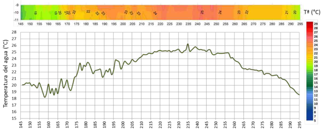
Figura 92. Año 2009. Gráfico superior: evolución térmica del embalse a 10 m de profundidad en la plataforma Flumen (datos cada 6 h, interpolados). Gráfico inferior: evolución térmica del embalse a 10 m de profundidad simulados por el modelo CE-QUAL-W2 (segmento 58, capa a 10 m de profundidad).
