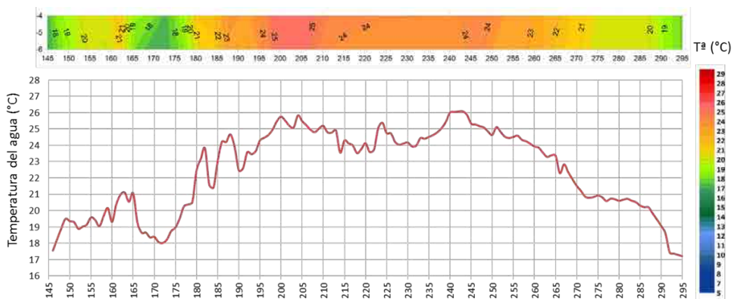
Figura 100. Año 2010. Gráfico superior: evolución térmica del embalse a 5 m de profundidad en la plataforma Flumen (datos cada 6 h, interpolados). Gráfico inferior: evolución térmica del embalse a 5 m de profundidad simulados por el modelo CE-QUAL-W2 (segmento 58, capa a 5 m de profundidad).
