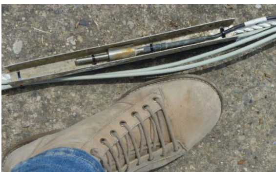
Figura 36. Detalle del termistor PT100 (marca Desin Instruments, modelo: PT100 SR-NXH-1/10 DIN de 3 hilos).
