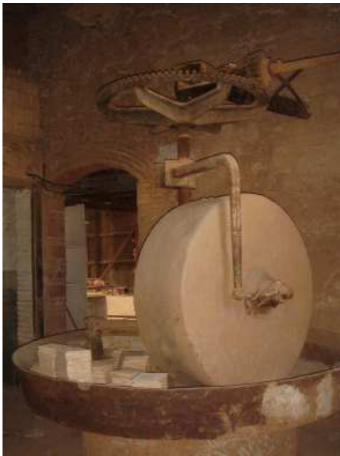
Mola de vernís. Taller de ceràmica de Josep Aragay a Breda, fundat l'any 1925.
