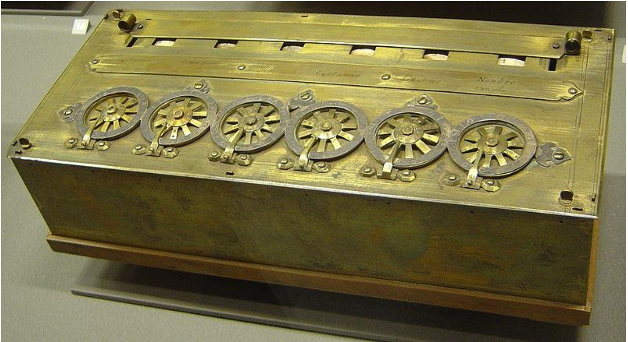
Figura nº 10: Pascalina, primera máquina de calcular creada en 1652 por Blaise Pascal con patente concedida por el rey de Francia. Foto: Wikimedia Commons http://pt.wikipedia.org/wiki/Ficheiro:Arts_et_Metiers_Pascaline_dsc03869.jpg
