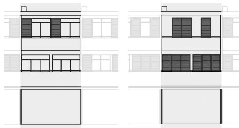
6.41 Helios sobre pilares. Celosías en posición abierta / cerrada. Alzados de la unidad tipo I. Fachada Norte y Sur. Dibujo CAD, MR.
