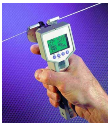
fig. 5-4 Sensor de fuerza para pequeños cables.
