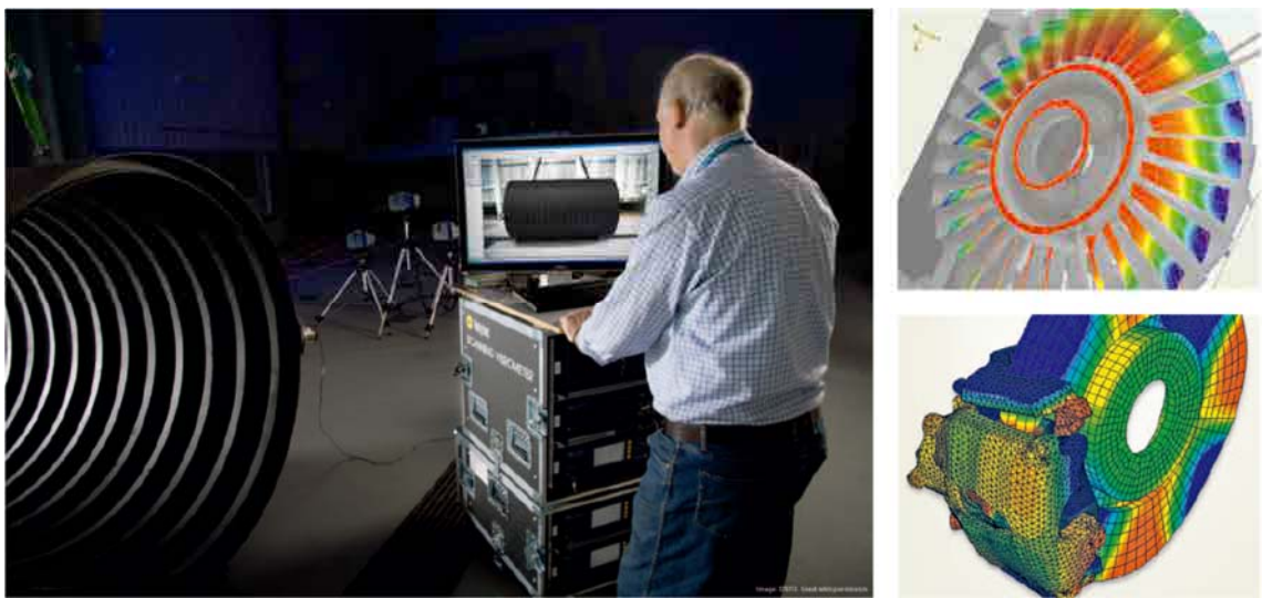
fig. 5-21 Imágenes obtenidas de un vibrómetro láser 3D.
