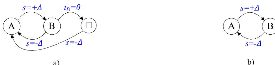
Fig. 4.29 Diagrama de transición de estado del d-Ćuk y m-Ćuk con a) tres o b) dos topologías diferentes.
