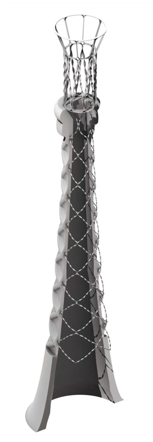
Il·lustració IV-35 Imatge virtual realitzada a partir del model tridimensional seccionat en part, deixant veure la malla metàl·lica de la totalitat de la peça.
