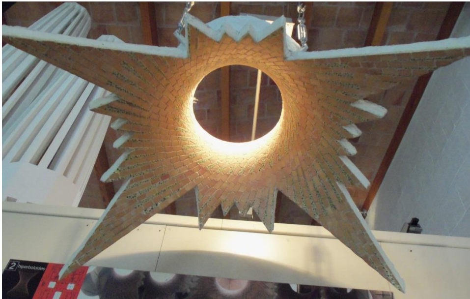
Il·lustració II-4 Fotografia de la maqueta d'un dels hiperboloïdes del sostre de la nau de la SAGRADA FAMÍLIA al museu de les Escoles Provisionals de la SAGRADA FAMÍLIA
