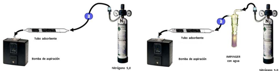
Figura 8.7. Montaje de la experiencia. El tubo de vidrio por donde se introduce la solución de siloxanos está situado en el punto a, entre la bombona de nitrógeno y el tubo de carbón activo (figura izquierda) o entre el impinger con agua y el tubo de carbón activo (figura derecha).
