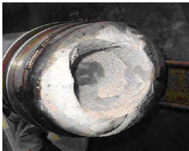
Figura 1.3. Depósito de sílice sobre un motor de gas [3].
