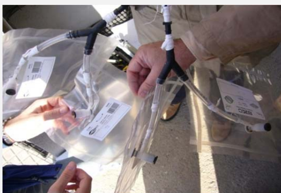
Figura 8.24. Muestreo con bolsas. En la imagen de la derecha se observa la conexión en forma de Y.
