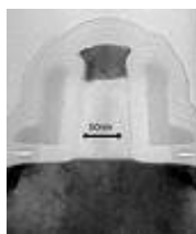
Figura 1.2 Transistor actual Intel de 50 nm de tamaño.
