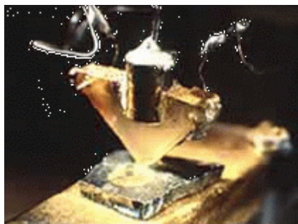
Figura 1.1 Primer transistor construido en el mundo por Bardeen y Brattain.
