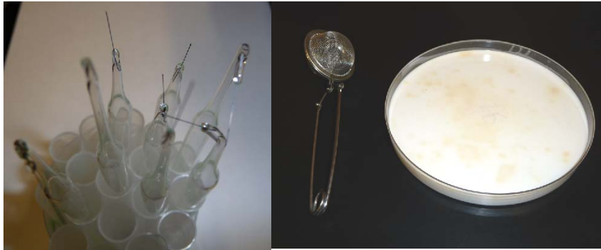
Figura 11. Aguja de tungsteno, placa de sylgard y bola metálica “para infusiones” utilizada para sumergir los cerebros en el medio de incubación.
