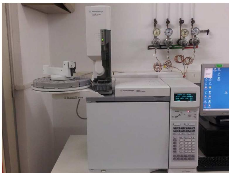
Figura 4.4. Cromatógrafo de gases HP 6890 Series GC System con FID.
