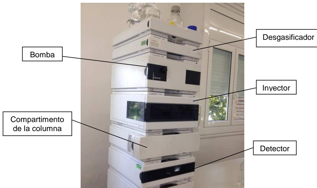
Figura 3.2. Cromatógrafo Agilent 1200
