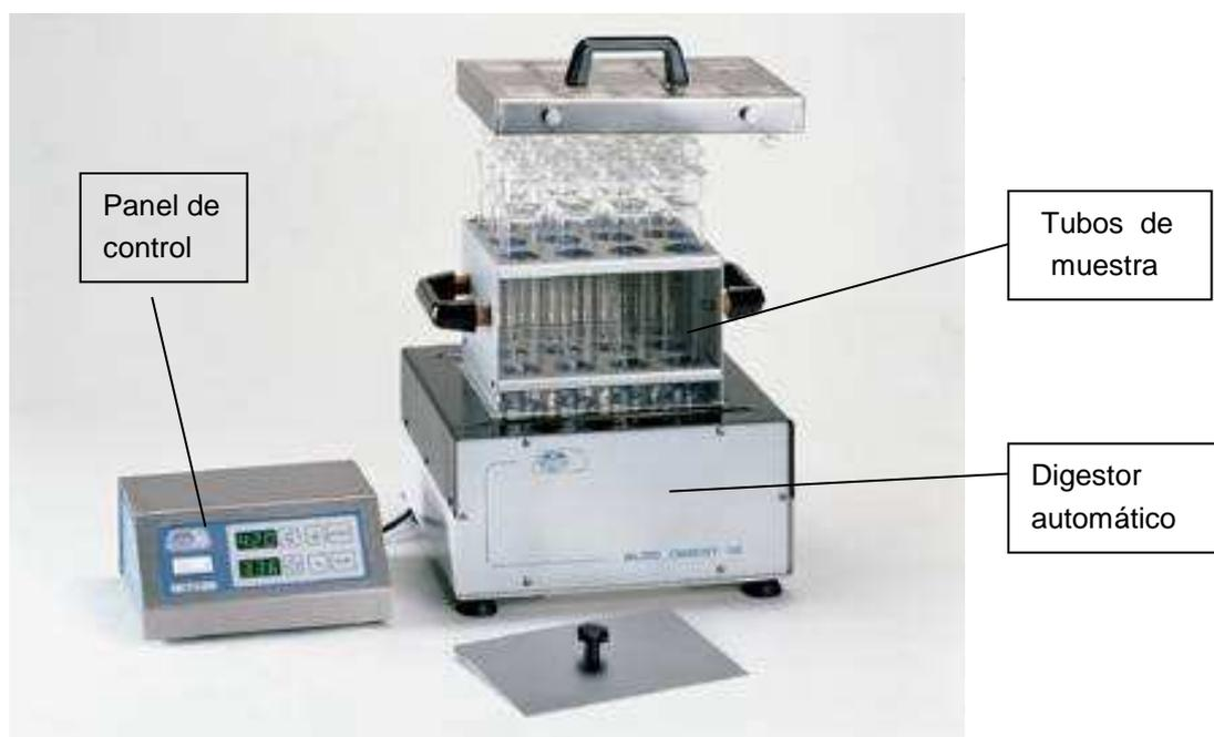
Figura 4.1. Bloque digestor JPSelecta.
