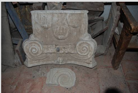
Fig. 29 Molde y contramolde de los capiteles
