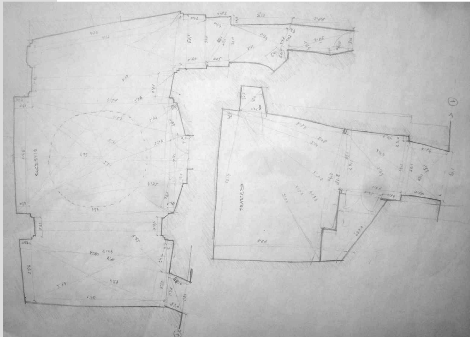
Fig. 30 Ejemplo de toma de medidas directa por triangulación, iglesia de Portell
