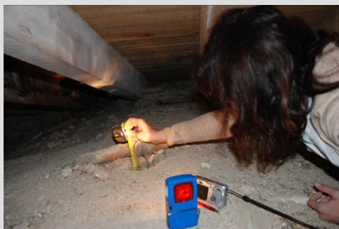
Fig. 13 Toma de medidas directa: bóvedas Castell de Cabres
