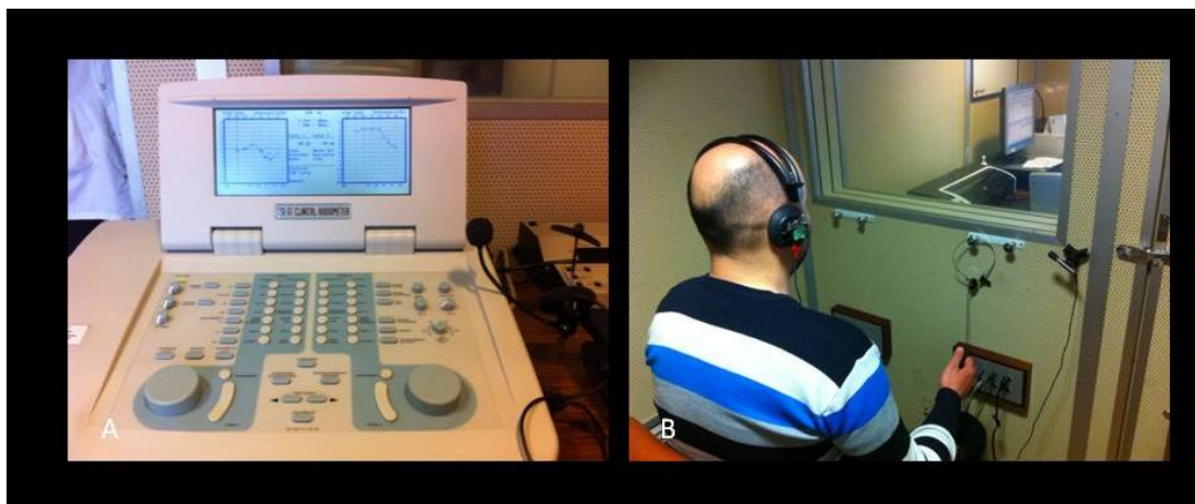
Fig. 35. A) Audiómetro tonal liminar y verbal de dos canales. B) Paciente realizándose una audiometría en el interior de la cabina insonorizada.
