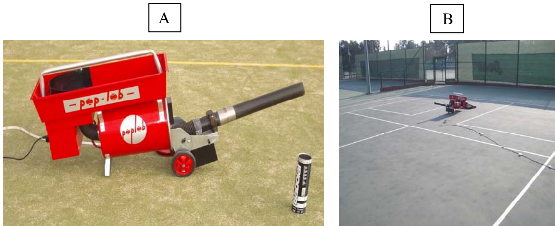
Figura I.4. Màquina llançapilotes (A) i la seva disposició a la pista de tennis (B).
