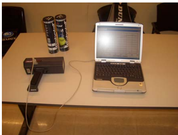
Figura I.8. Radar utilitzat per mesurar la velocitat de llançament de la màquina llançapilotes.
