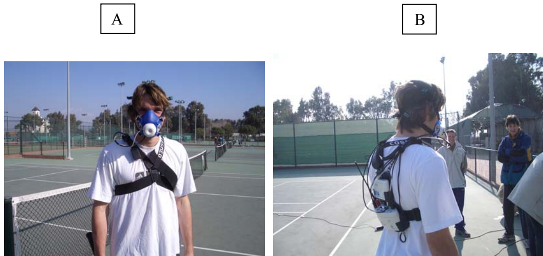
Figura I.5. Visió frontal (A) i lateral (B) d'un jugador amb l'analitzador de gasos portàtil col·locat a l'esquena mitjançant un arnés.
