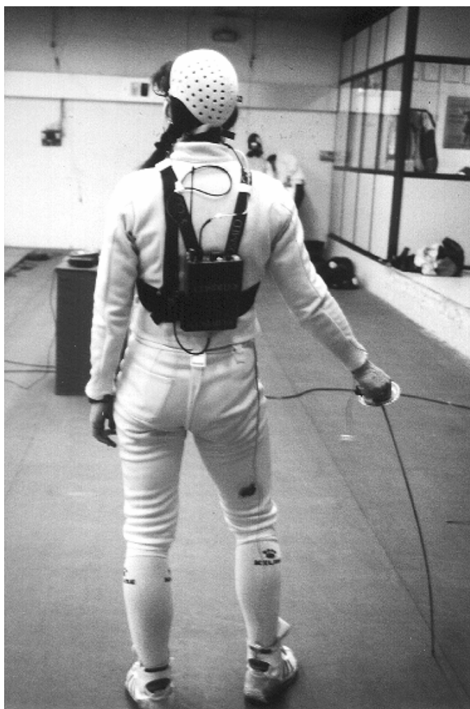
Foto 4-4: Visió posterior de la disposició de l'analitzador telemètric de gasos en una de les esgrimadors de la mostra.
